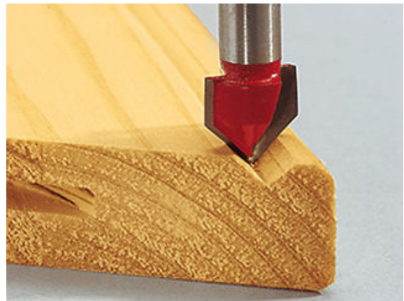
Abbildung 012: Gefräste Tropfnase (Tropfkante)
