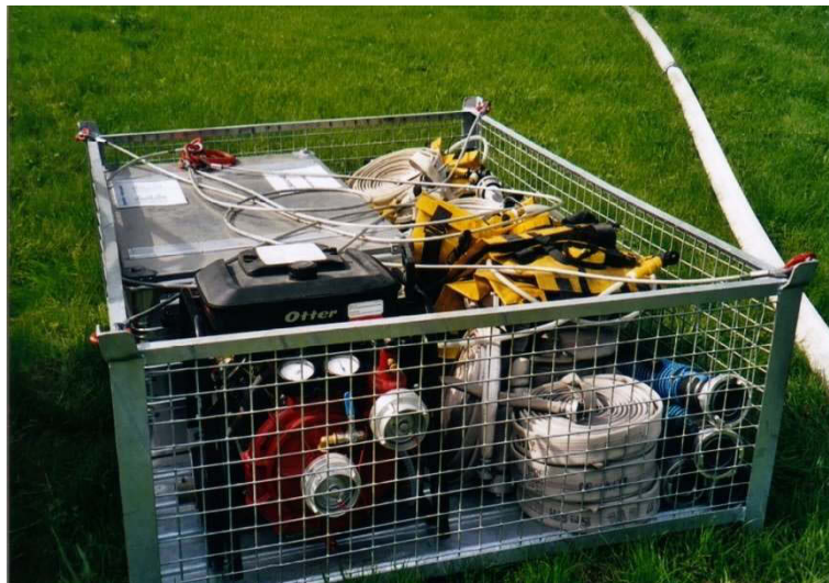
Abb. 39: Waldbrandbox, wie sie zur Waldbrandbekämpfung verwendet wird. (HAFELLNER, 2004)
