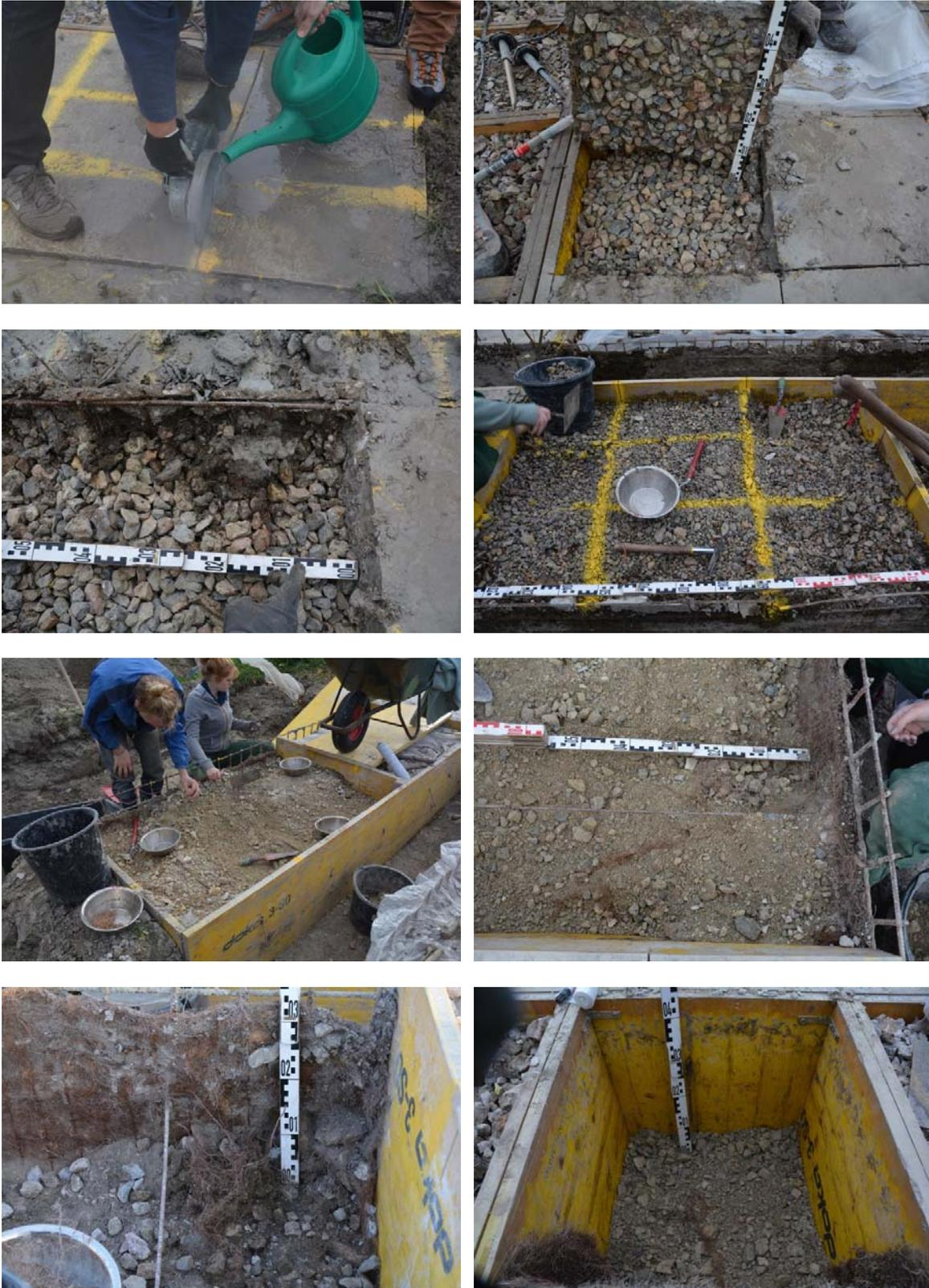
**Abbildung 32: Bearbeitung der Wegeaufbau-Versuchsboxen und Aufnahme der unterirdischen Biomasse in 3 Ebenen (Großenzersdorf, Oktober– November 2015)**
