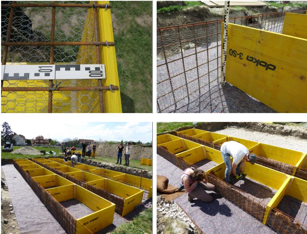
**Abbildung 15: Bau von Wegeaufbau-Versuchsboxen mit Baustahlmatte, Drahtgitter, Kokosmatte und Bewehrungsseisen in Reihen (Großenzersdorf, 27.-30.4.2015)**
