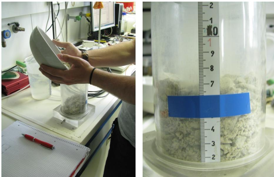
**Abbildung 22: Befüllung des Zylinders mit der Substratprobe (Wien, 15.05.2015)**
