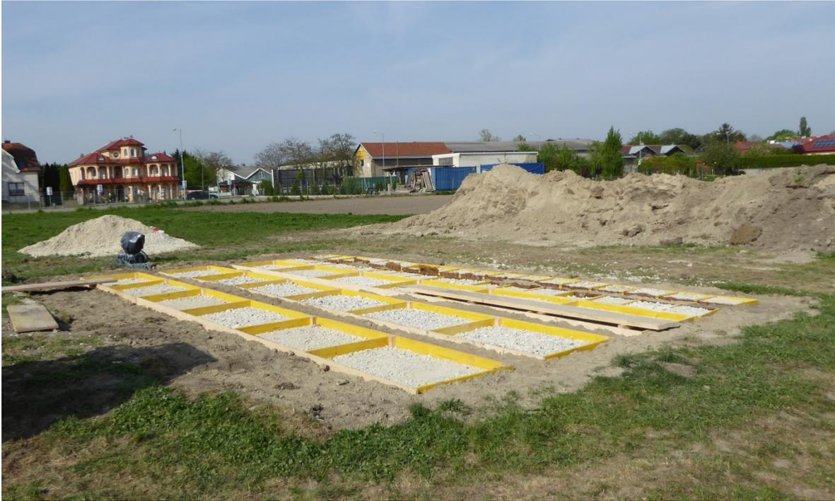
**Abbildung 18: Fertig befüllte Versuchsanlage mit allen Tragschichten und Gehölzpflanzstreifen (Großenzersdorf, 27.-30.4.2015)**
