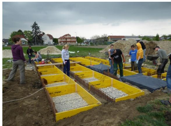
**Abbildung 16: Lagenweise Befüllung und Verdichtung der Wegeaufbau-Versuchsboxen (Großenzersdorf, 27.-30.4.2015)**
