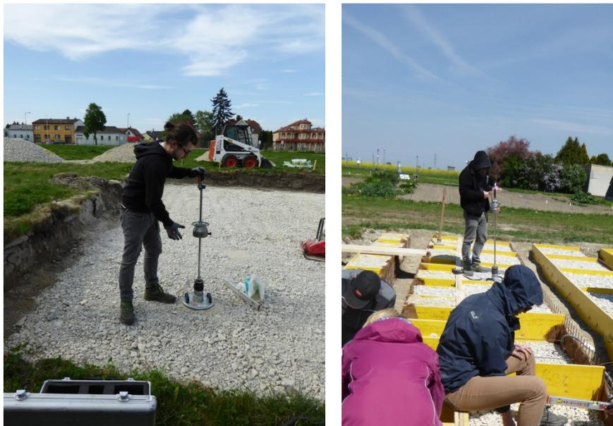
**Abbildung 26: Dynamische Lastplattenversuche auf der unteren und oberen Tragschicht (Großenzersdorf, 27.-30.4.2015)**
