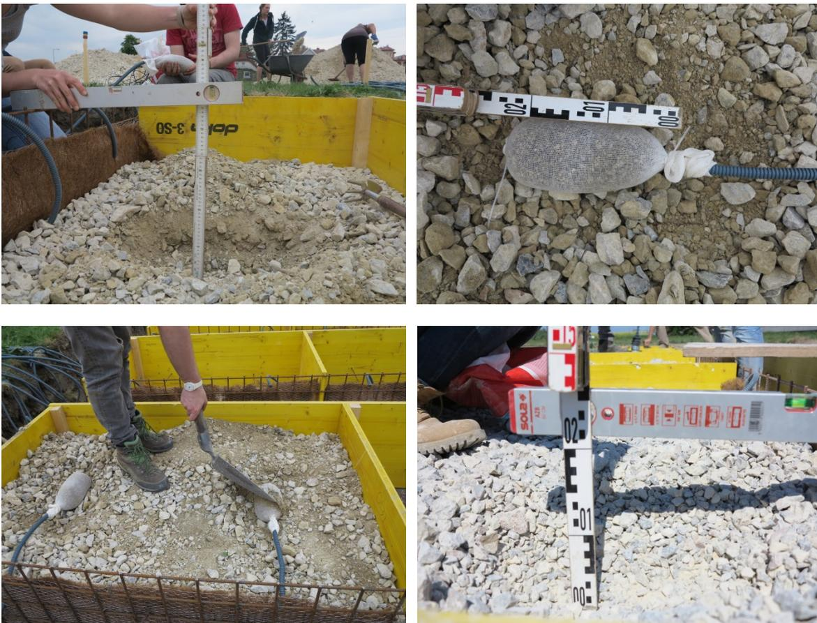
**Abbildung 21: Einbau der Wassergehaltssensoren in 45 cm und 15 cm Tiefe (Großenzersdorf, 27.-30.4.2015)**
