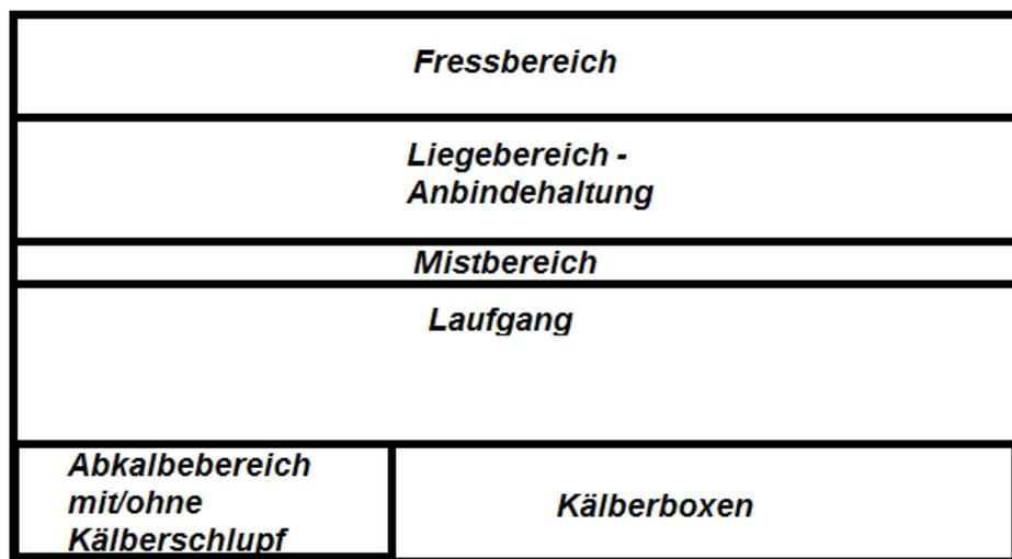
**Abbildung 1:** Skizze eines Anbindestalles in der Mutterkuhhaltung mit eigenem Abkalbebereich.
