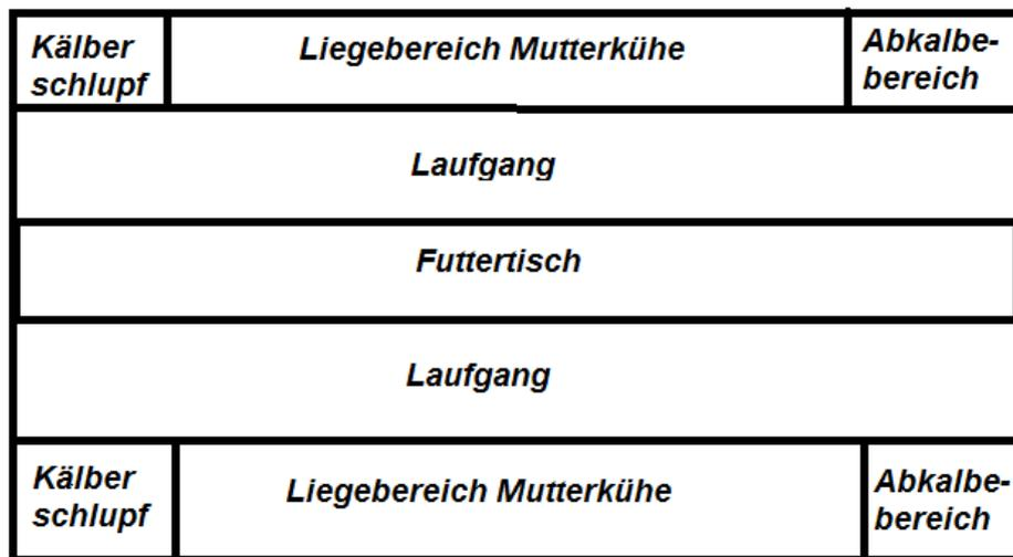
**Abbildung 2:** Skizze eines Laufstalles in der Mutterkuhhaltung inklusive eigenem Abkalbebereich mit Kälberschlupf.
