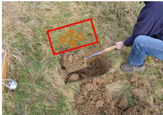
5. Für die richtige Probenahmetiefe wird ein 3 cm hoher Metallring in den Einschlagadaptor gegeben, gefolgt von dem Stechzylinder
