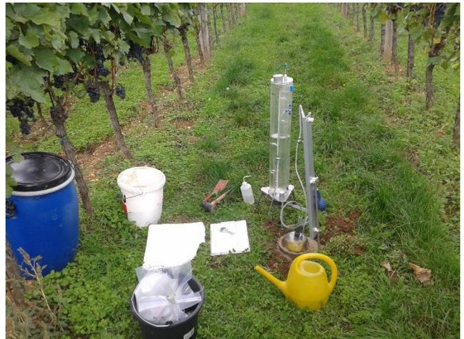
Abbildung 26: Platzierung des Haubeninfiltrometers in der Fahrgasse
