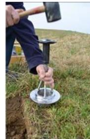
7. Der Stechzylinder ist korrekt eingeschlagen, wenn der Boden den Stechzylinder für ungefähr 1 cm überlappt
