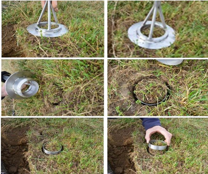
9. Nachdem alle Zylinder eingeschlagen wurden, wird der Boden von allen Seite vorsichtig entfernt
