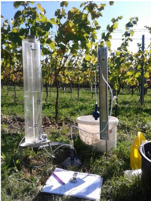
Abbildung 25: Aufbau des Haubeninfiltrometers bei Feldmessungen
