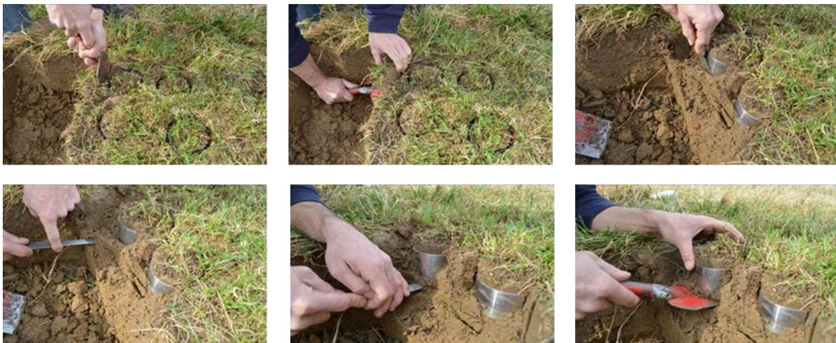
12. Die beiden Seiten des Zylinders werden mit einem scharfen Messer bis zur Kante des Zylinders getrimmt.
