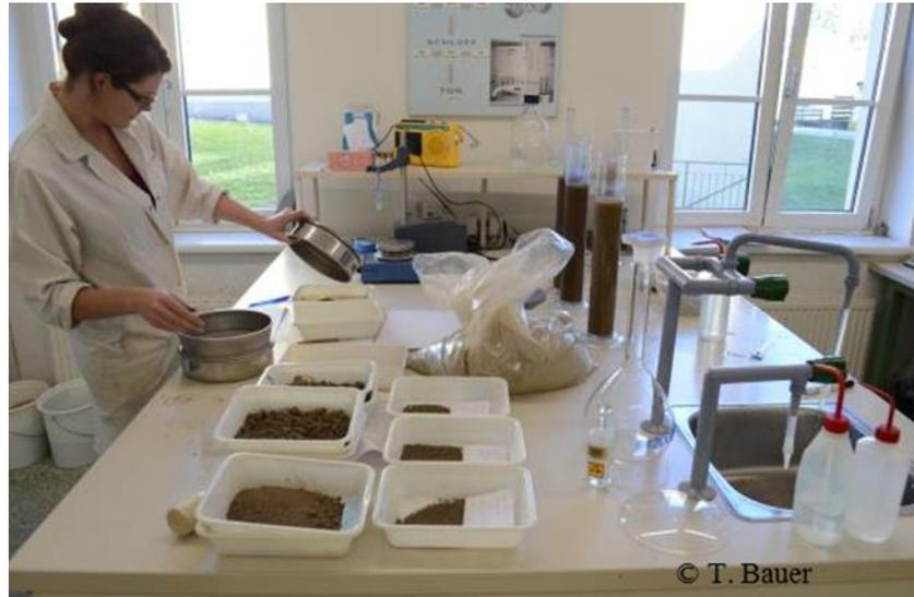
Abbildung 16: Siebung der Bodenaggregate
