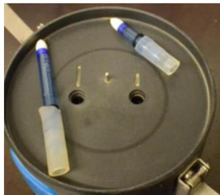
Abbildung 22: Hyprop: Sensoreinheit mit den zwei Kerzen der Tensiometer
