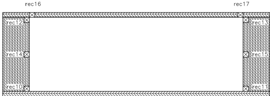
Abb. 40: schematische Skizze zu den aufgezeichneten Recorderpositionen
