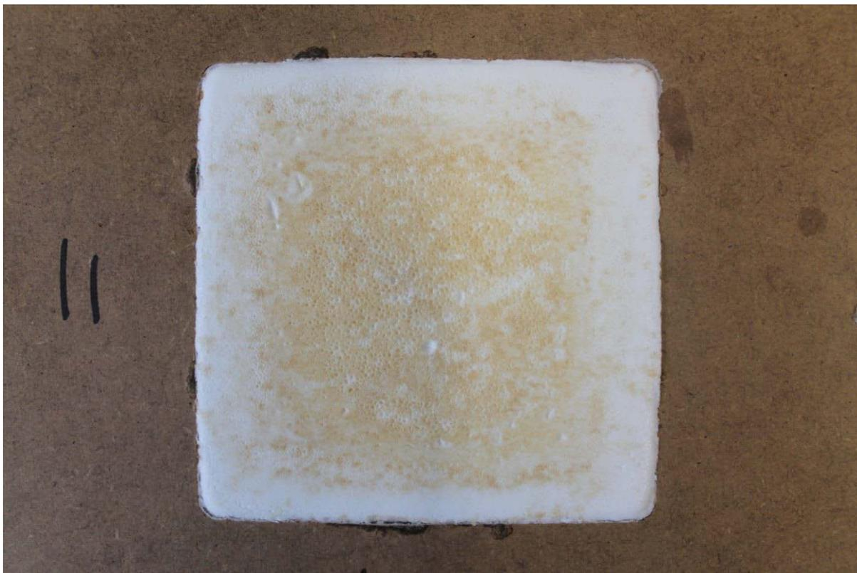
**Abbildung 33: Verteilung der Bläschen an der Oberfläche einer ausgehärteten Probe**
