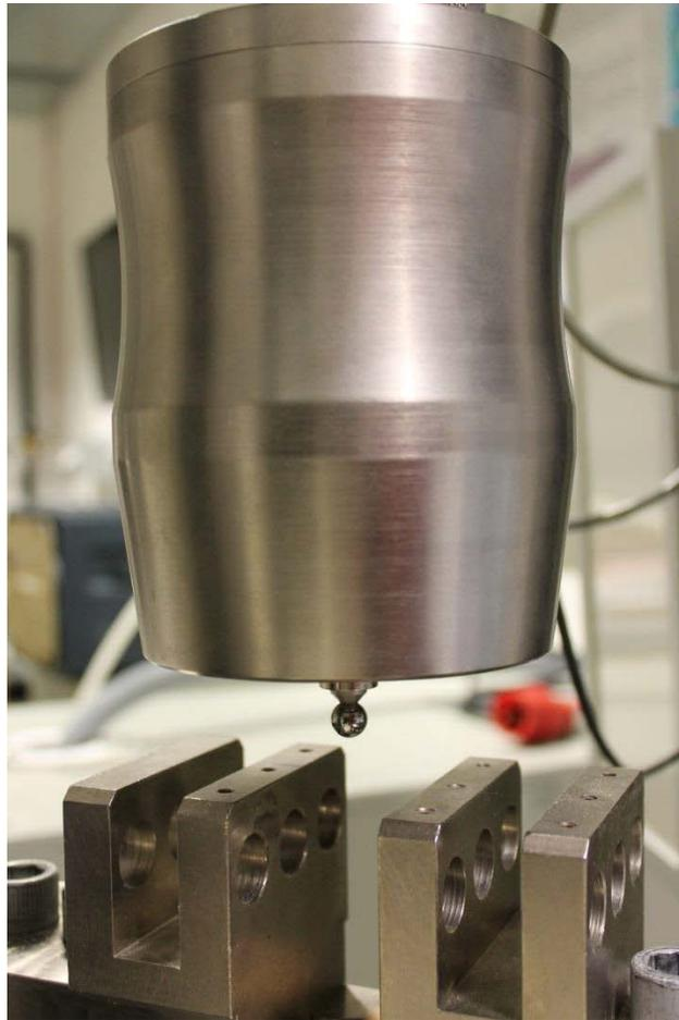
**Abbildung 8: Aufbau der Zwick020 für Messung der Biegefestigkeit**
