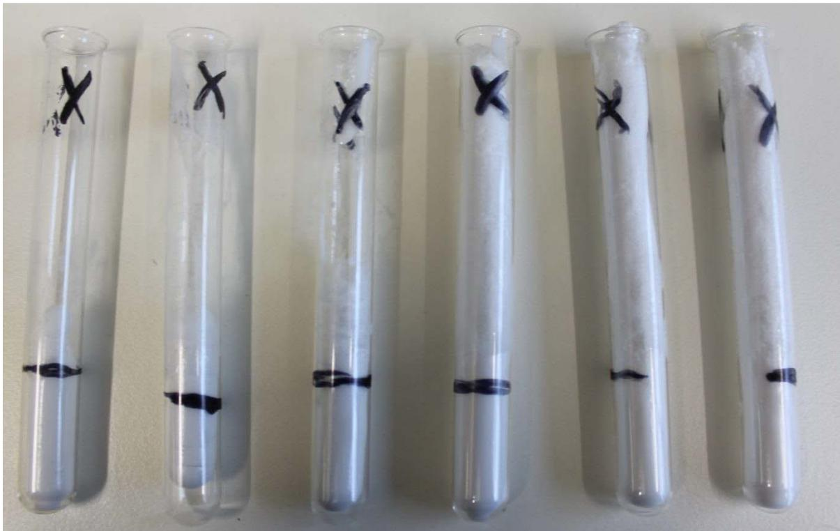
**Abbildung 4:** Mit Expancel versetzte Leimmischungen in Eprouvetten, in aufsteigender Reihenfolge der Temperaturen (103/120/140/160/180/200°C von links nach rechts) ausgehärtet
