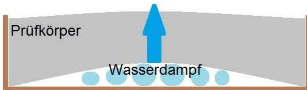
**Abbildung 34: Wasserdampfdruck im Zuge des Aushärteprozesses**
