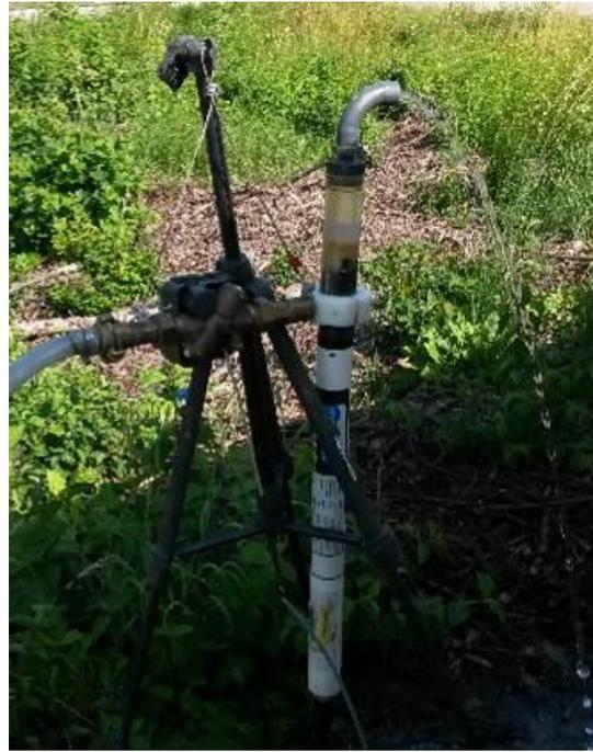
Abbildung 27: Multimesssonde während Pumpvorgang
