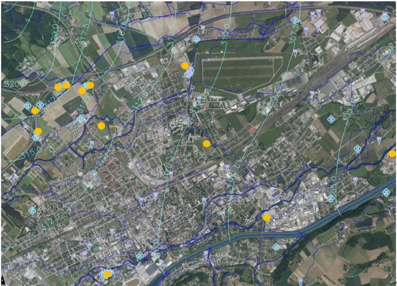
Abbildung 81: Grundwassergleichen nach Beprobung im Juli
