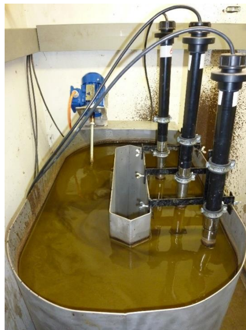
Abbildung 7: Gülleversuchsbehälter inklusive Messsonden und Rührwerk während des Versuchsablaufs
