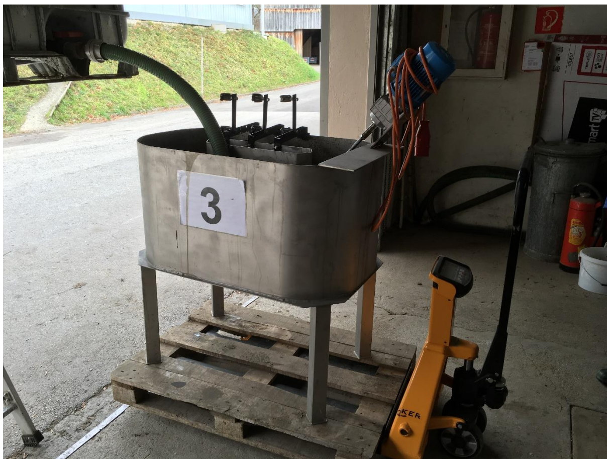
Abbildung 4: Befüllung der Gülleversuchsbehälter mit 90 kg Rohgülle für die anschließende Variantenbildung
