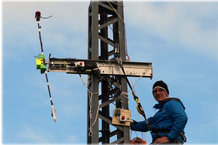
Abbildung 3.45: Experimenteller Aufbau für Eiswurf-Untersuchungen bei KWEA.
