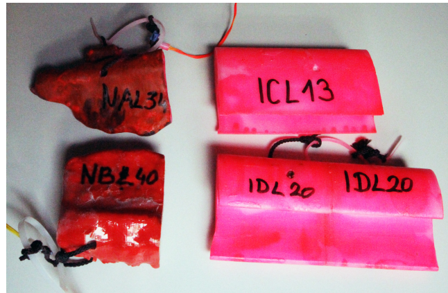
Abbildung 3.48: Probekörper für Eiswurf. Der Kabelbinder für Schnellmontage und die Zündkapsel mit Verkabelung sind links oben und unten zu erkennen.
