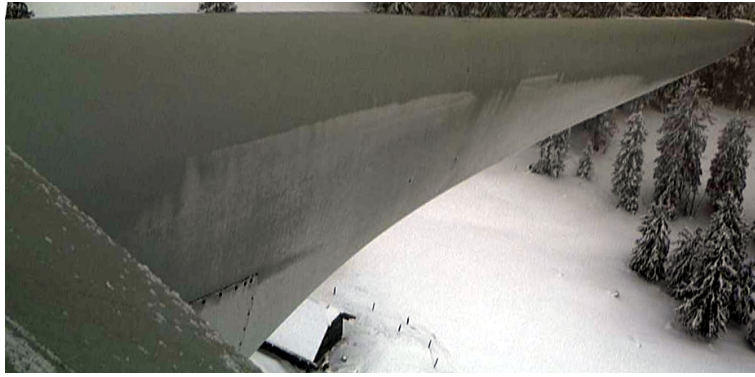
Abbildung 3.8: Beispiel für flächige Vereisung, erkennbar an der windabgewandten Seite des Rotorblattes
