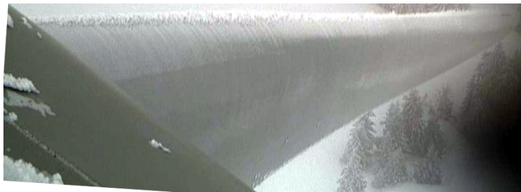
Abbildung 3.9: Raueisbildung verstärkt an der Vorderkante, aber auch an der Leeseite des Rotorblattes
