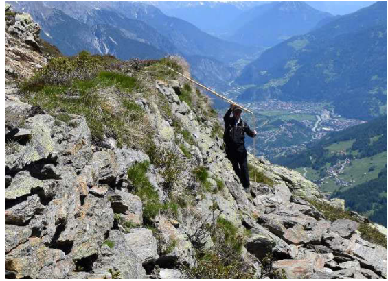
Abbildung 5: Links: Definition der Höhenbezeichnungen (Margreth & Blum, 2011); Rechts: Messung der Werkhöhe H_K vor Ort
