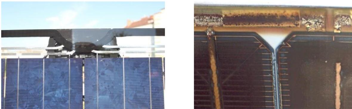
**ABBILDUNG 2** Doppelglas Modul mit Speziallaminierung nach 3.000 Stunden Dampftest (links), korrodiertes Standardmodul (Glas-Folie ohne Laminierung) nach Einsatz auf den Malediven (rechts) (Quelle: Swimsol 2014)
