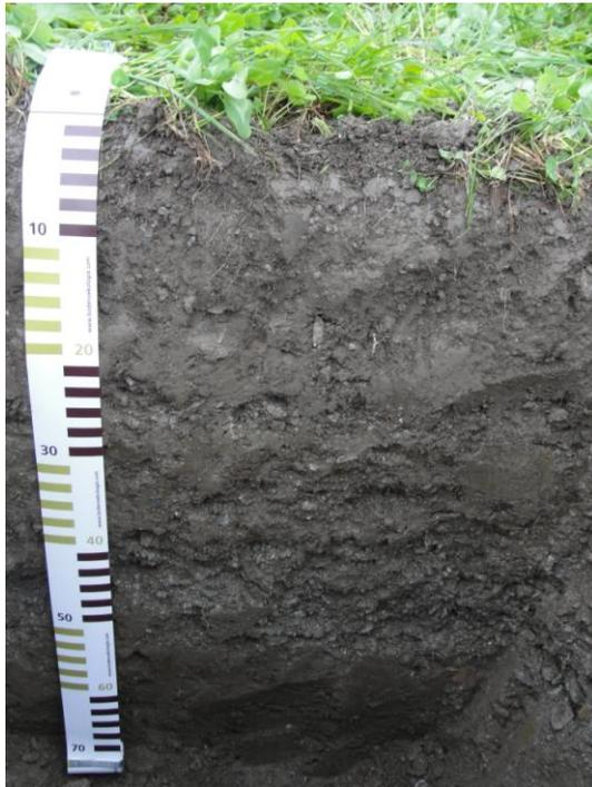
Abbildung 6: Bodenprofil im Freiland, Betrieb E (mittelgründige Lockersediment-Braunerde/Grauer Auboden)
