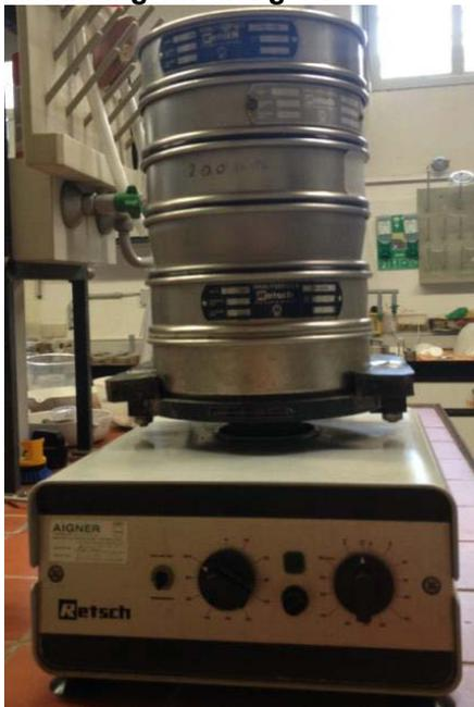
Bei der Siebanalyse werden mehrere Siebe mit unterschiedlich großer Maschenweite (2 mm – 20  $\mu\text{m}$ ) gestapelt auf einen vibrierenden Siebboden gestellt. Das Material wird als Suspension und mit Hilfe von destilliertem Wasser durch die Siebe befördert. Jenes Material, welches kleiner 20  $\mu\text{m}$  ist, wird in einem Behälter aufgesammelt und später im SediGraph weiter untersucht. Im Anschluss werden die Proberückstände aus den Sieben in einem Ofen mit 105° C getrocknet und gewogen.
