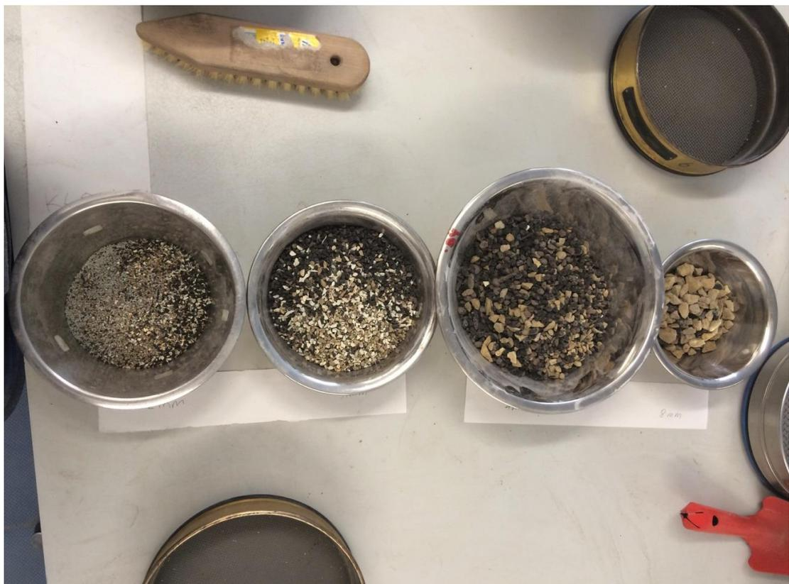
*Abbildung 20:Baumsubstrat nach Siebung in Behältnissen v.l.n.r 1mm, 2mm, 4mm und 8mm Körnung*
