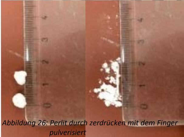
Abbildung 26: Perlit durch zerdrücken mit dem Finger pulverisiert
