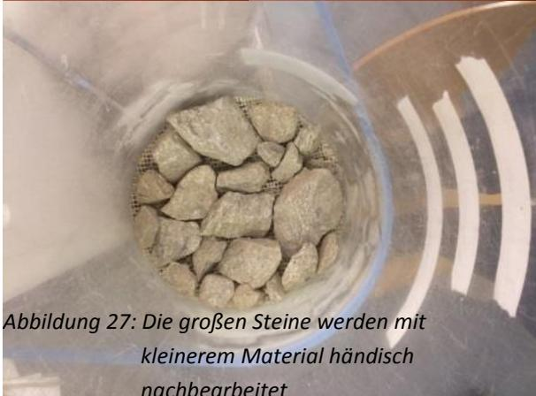
Abbildung 27: Die großen Steine werden mit kleinerem Material händisch nachbearbeitet
