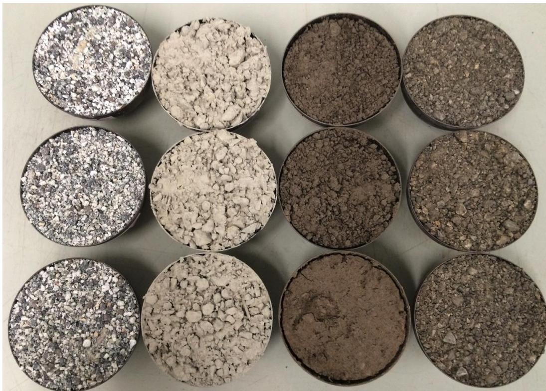
*Abbildung 32: Jeweils 3 Proben von 4 unterschiedlich zusammengesetzten Baumsubstraten nach Trocknung bis zur Massenkonstanz*
