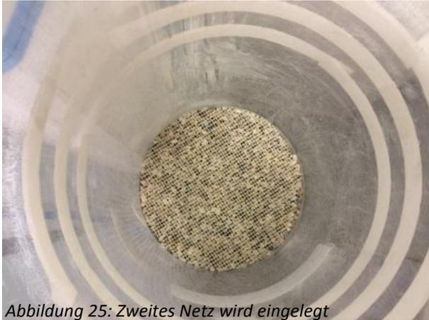
Abbildung 25: Zweites Netz wird eingelegt
