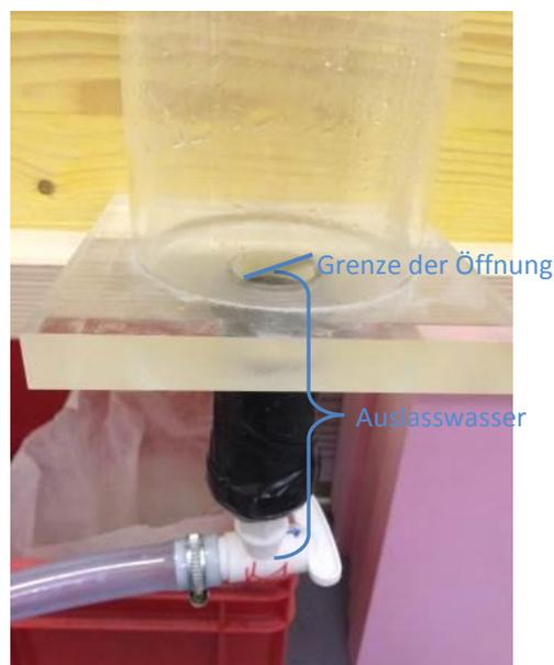
*Abbildung 21: Ventilfüllmengentest: mit der Grenze der Öffnung und der bildlichen Darstellung des Auslasswassers*
