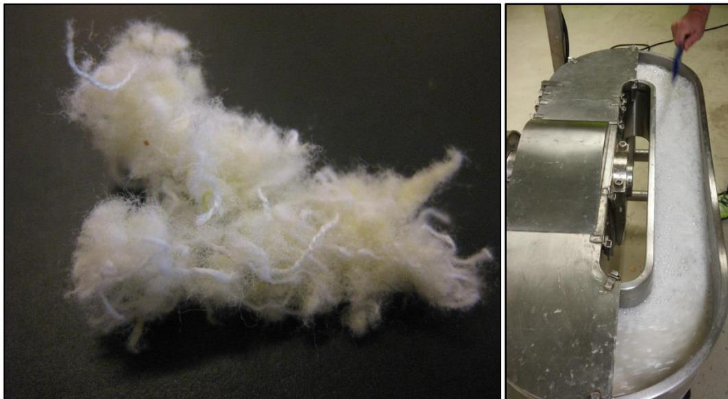
**Abbildung 3:** Durch den Prozess gewonnene Alttextilfasern und eingesetztes Material im Labor-Holländer
