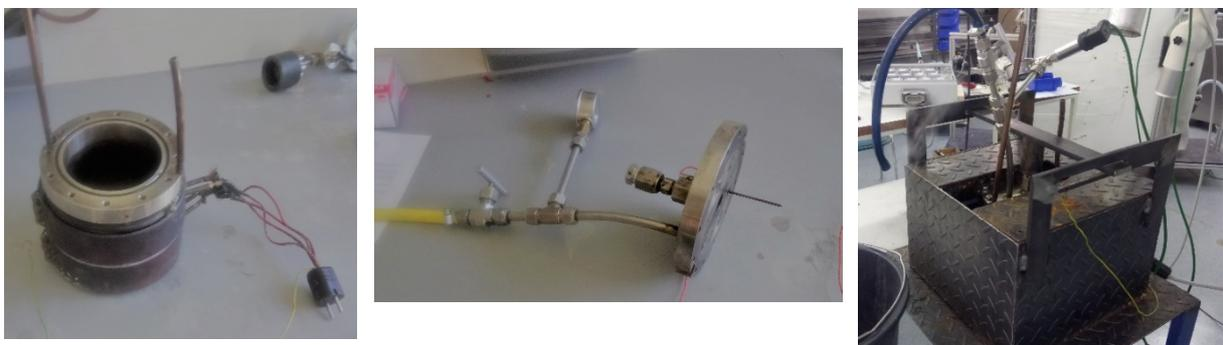
Abb. 6: Reaktoraufbau: HTC- Reaktor, Deckel mit Druck- und Temperatursensor, Stahlbox
