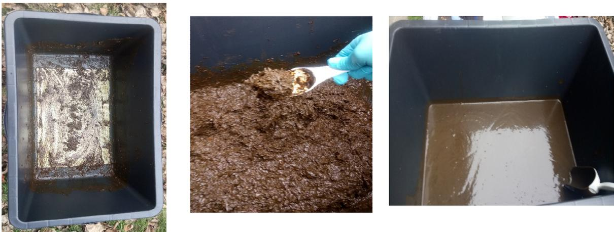
Abb. 7: Sieb, Auftrennung der Biogasgülle in Filterkuchen (mitte) und Filtrat (rechts)
