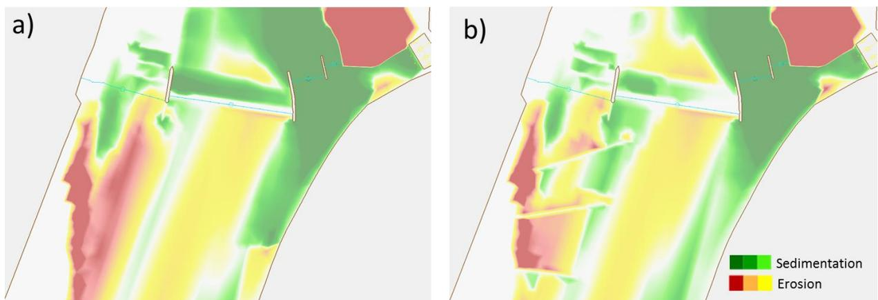
**Abbildung 53: Sedimentation / Erosion HQ<sub>1</sub> bei Abflussspitze mit LZA 26, aktuell (a) und mit Maßnahmen (b) aus Geschiebemodellierung**
