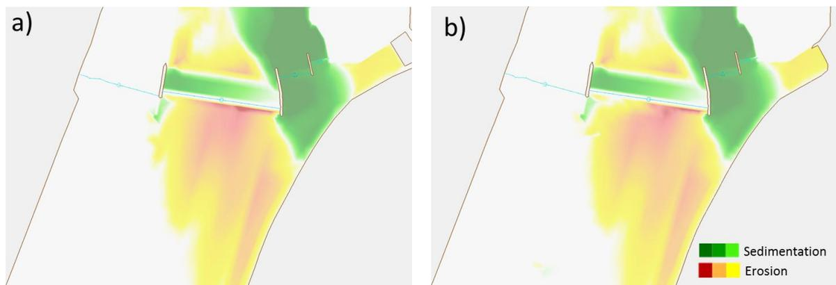
**Abbildung 69: Sedimentation / Erosion nach fünf Tagen MQ - Schütze offen aktuell (a) und mit Maßnahmen (b) aus Geschiebemodellierung**
