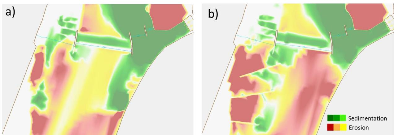
**Abbildung 54: Sedimentation / Erosion rot HQ<sub>1</sub> nach dem Ereignis mit LZA 26, aktuell (a) und mit Maßnahmen (b) aus Geschiebemodellierung**
