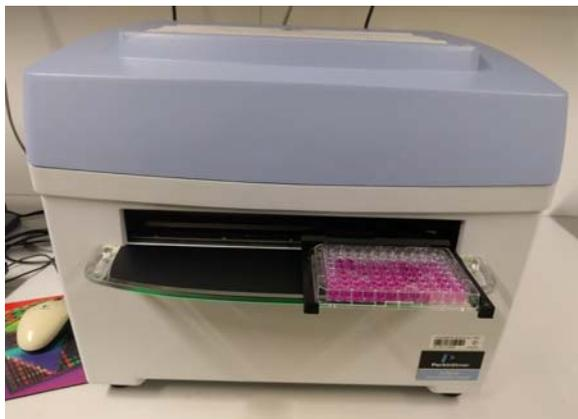
**Abbildung 15: Microplate cellstar eingelegt in den „EnSpire 2300 Multilabel Reader“ für die Messung des Nitratgehaltes (E. A.).**
