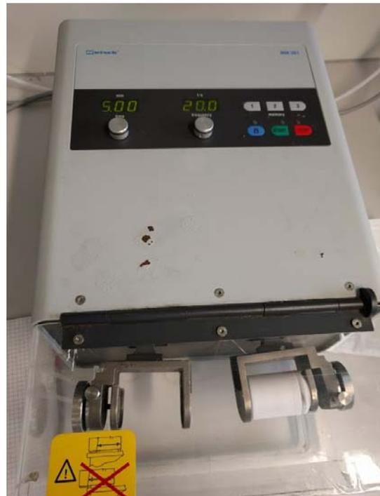
**Abbildung 12: Schwingmühle MM 301 der Firma Retsch zur Homogenisierung von Lösungen (E. A.).**
