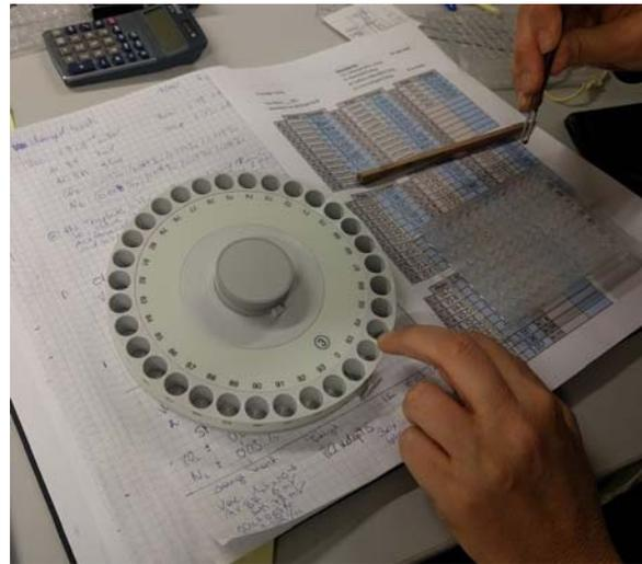
**Abbildung 18: Einlegen der Proben in die Bestückungsscheibe für die Isotopenverhältnis- Massenspektrometrie (IRMS) (E. A.).**
