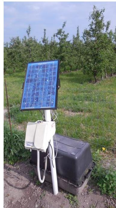
Abbildung 5: Datenspeicher am Versuchsfeld mit Solar-Panel (Lischka 2017)
