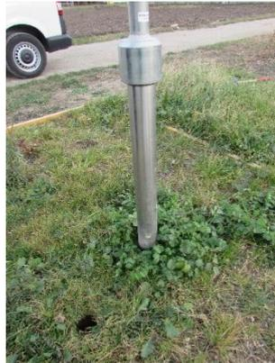
**Abbildung 32: Bodenbohrer bei der Entnahme des Bohrkerns (30.11.2016)**
