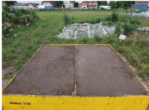
**Abbildung 29: Fertiggestellte Versuchsanlage mit (li) V 1 - schluffig und (re) V 2 - sandig (15.07.2016)**
