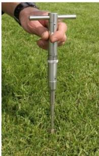
**Abbildung 58:** Flügelsonde zur Bestimmung der Scherfestigkeit
