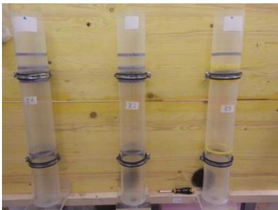
**Abbildung 52:** Säulen zur Messung der Wasserspeicherkapazität und des Porenvolumens
