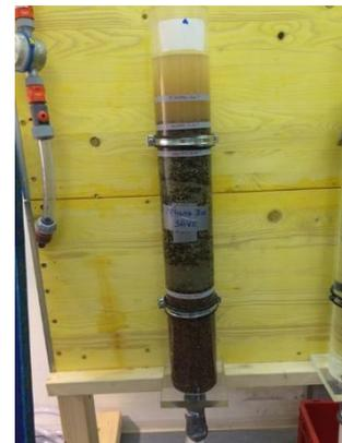
**Abbildung 54:** Säulenversuch mit Wasser aufgefüllt (KOS, 2016)
