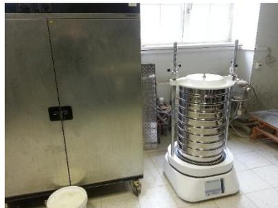
**Abbildung 47: Siebturm mit Trockenschrank**
