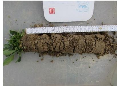
**Abbildung 33: Frischer Bohrkern mit oberirdischer Biomasse (30.11.2016)**
