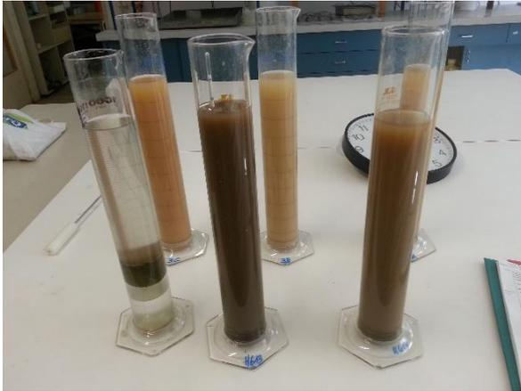
Abbildung 49: Aräometerversuch (25.03.2017)
