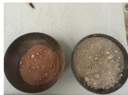
Abbildung 57: Bodenproben (li) nach dem Verglühen (re) vorm Verglühen
