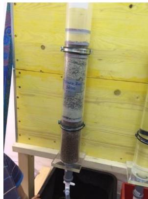
**Abbildung 53:** Schichtweiser Einbau des Substrates und Drainschicht (KOS, 2017)
