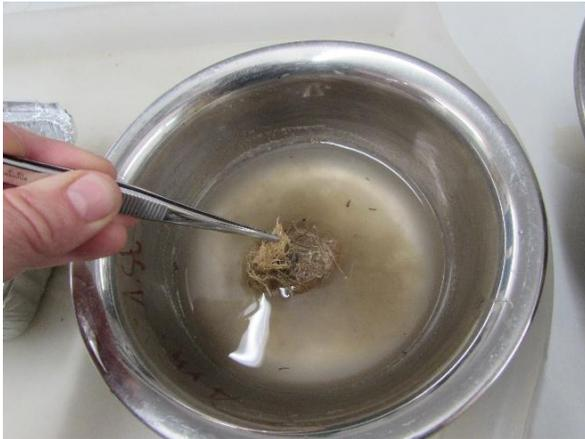
**Abbildung 40:** Feinere Auswaschung des Bohrkerns
