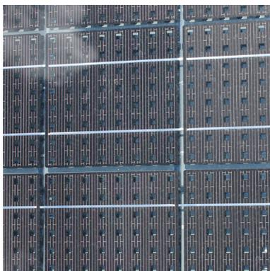
Abbildung 23: PV-Modul gelochte Zellen, 01.07.2014 (EIGENE ERSTELLUNG).
