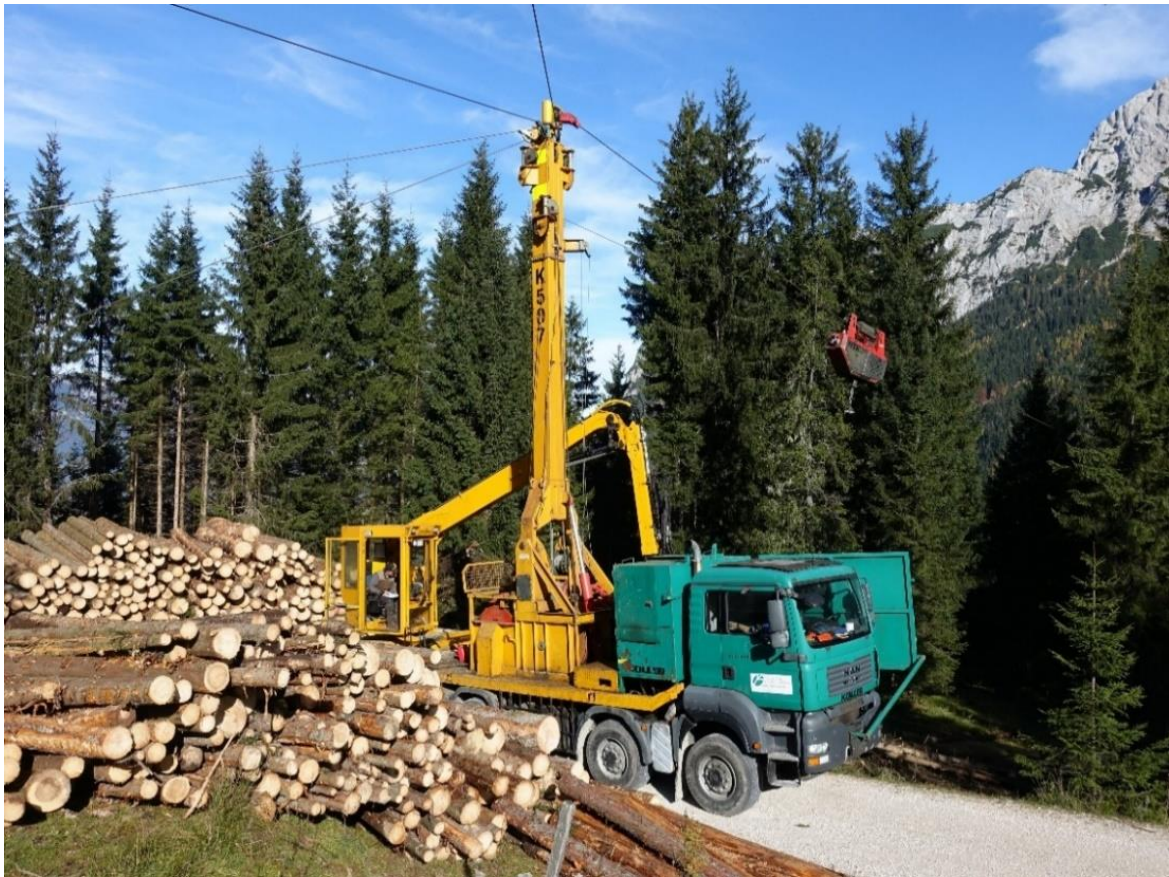
Abbildung 27: Mastseilgerät Koller K 507 mit Laufwagen Koller MSK 3
