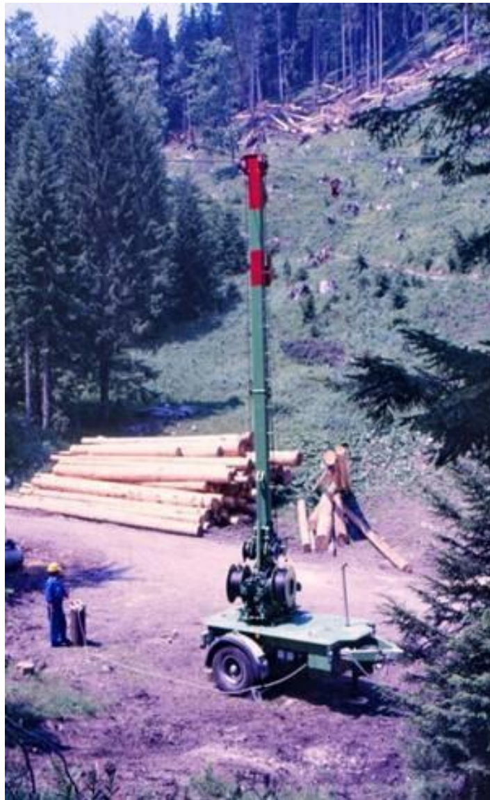
Abbildung 8: Seilgerät Turmfalke 2,5 to (Foto: MMForstTechnik)
