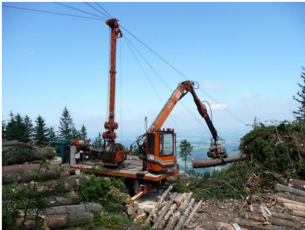
Abbildung 9: Syncrofalke 2,5 to mit Ladekran Vkran 20.88 und Prozessor Woody 50
