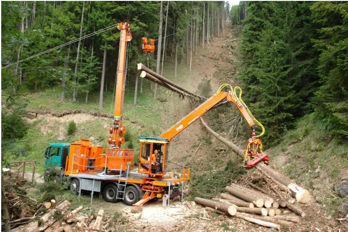
Abbildung 29: Mastseilgerät Syncrofalken 4 to der FTBaySF (Foto MMForstTechnik)
