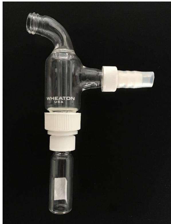
Abbildung 5: Wheaton Glasadapter mit Glasröhrchen und Filterpapier (Foto: Riegler A.).
