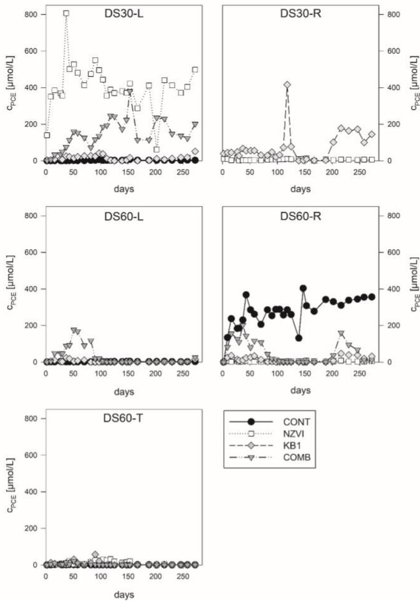
Fig. S.1: PCE concentrations at DS30-L, DS30-R, DS60-L, DS60-R and DS60-T of chamber CONT, NZVI, KB1 and COMB
