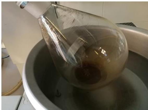
**Abbildung 24: Primärdünger im Verdampferkolben**
