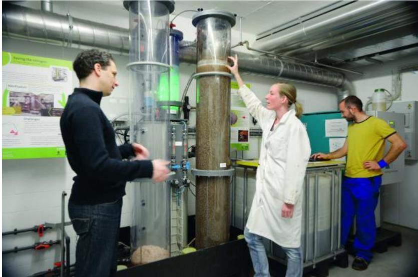
**Abbildung 8: Nitrifikationsanlage (Etter et al., 2015, 6)**
