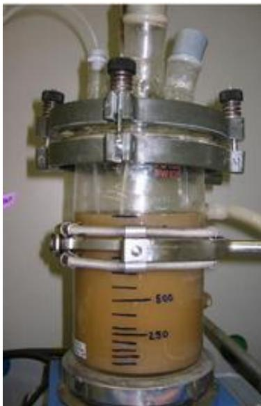
**Abbildung 11: Phosphoreliminationsanlage (Larsen und Lienert, 2007, 13)**
