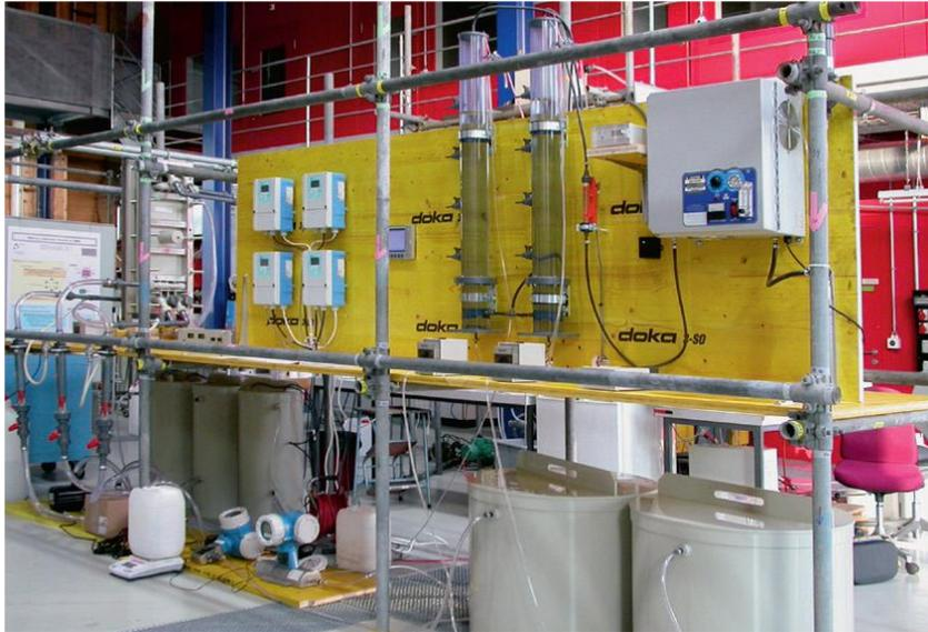
Abbildung 6: Pilotanlage zur Urinaufbereitung, Eawag (Maurer, 2007, 21)
