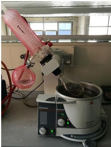
**Abbildung 27: Rotationsverdampfer**
