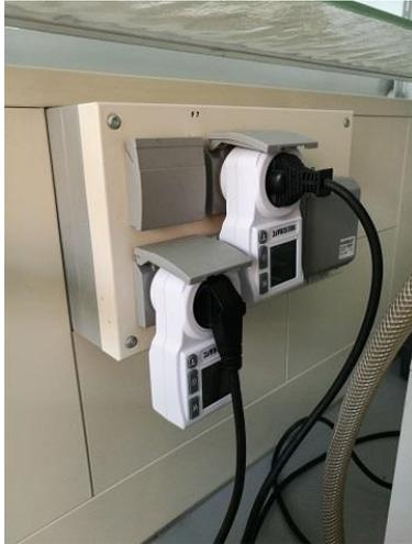
**Abbildung 26: Energiemessgeräte Voltcraft**
