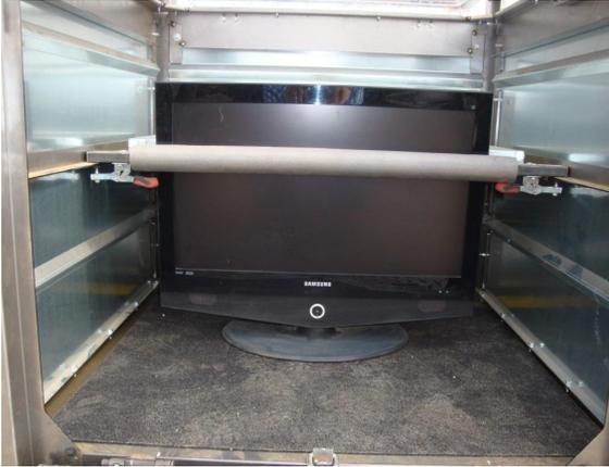
Abbildung 15: „Relectro“-Container-Ladungssicherung 2015 (Eisenriegler et al., 2015)
