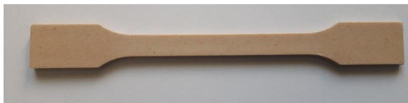
**Abbildung 6: WPC Probe zur Bestimmung der Poissonzahl**
