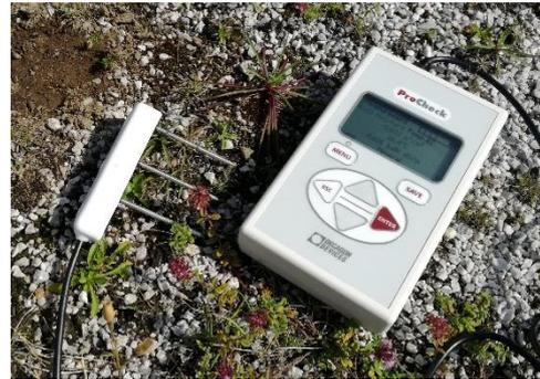
Abbildung 22: Messgerät zur Bestimmung des Bodenwassergehalts, des Salzgehalts und der Temperatur (Quelle: EIGENE AUFNAHME, 2017)
