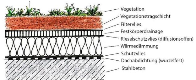
Abbildung 11: Umkehrdach (Quelle: EIGENE DARSTELLUNG, 2018; vgl. ZIMMERMANN, 2011, 458f)
