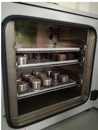
Trocknungsphase der Bodenproben im Trockenschrank
