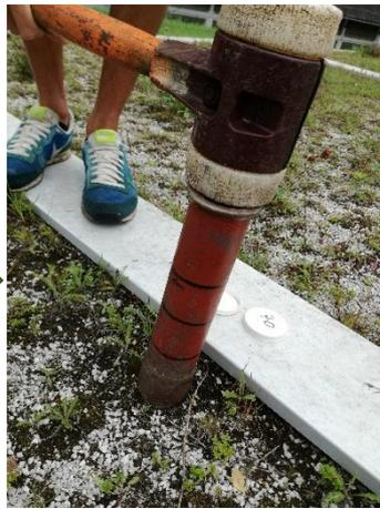
Steckzylinderentnahme mittels Hammer
