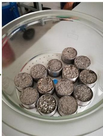
Befüllen des Exsikkators mit den getrockneten Bodenproben
