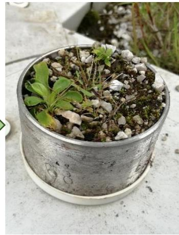
Entnommene Bodenprobe im Steckzylinder
