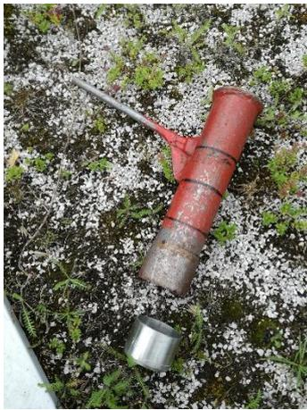
Werkzeug zur Entnahme von Bodenproben mithilfe von Steckzylindern
