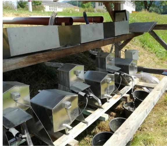
Abbildung 24: Messstation/Auffangbecken des Beregnungsversuchs ZU-860 (Quelle: EIGENE AUFNAHME, 2017)
