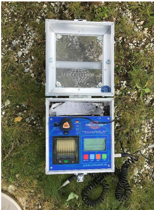
Abb. 16 Gerät zum Messen, Speichern und Drucken der Tragfähigkeitsergebnisse, eigene Abbildung 2017
