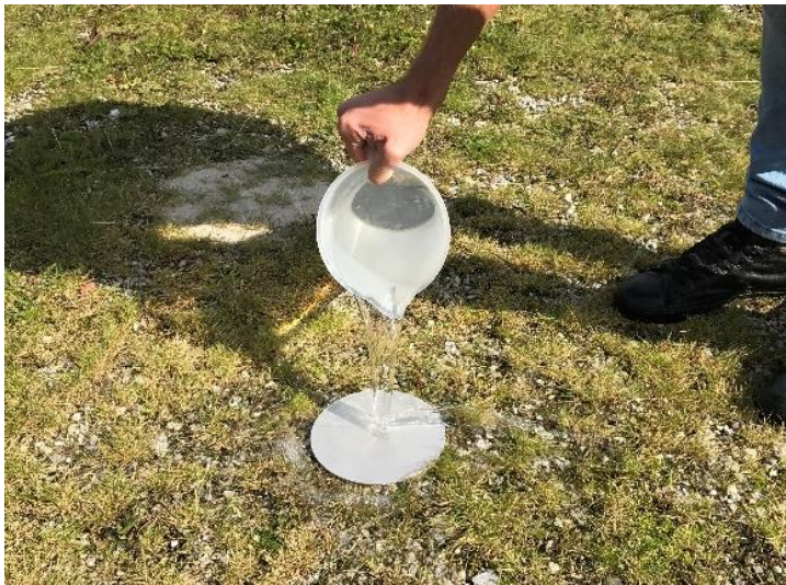
Abb. 15 Ausschüttversuch nach Pregel, eigene Abbildung 2017
