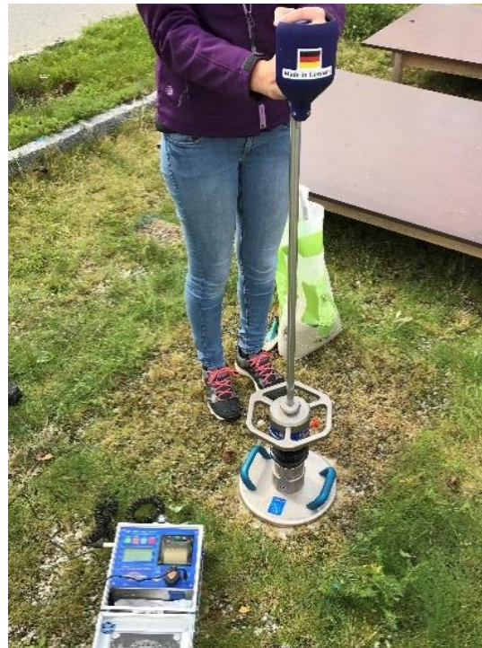
Abb. 17 Messung der Tragfähigkeit mittels einer Lastplatte, eigene Abbildung 2017
