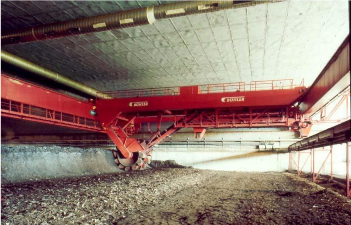
Abbildung 11: Umsetzgerät "Wendelin" (BÜHLER) für Tafelmieten (Kranert et al., 2017)
