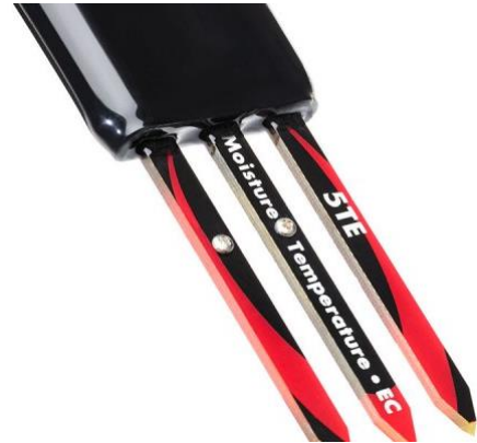
Abbildung 23 Sensoren des Typs Echo 2 5 TE, METER Group AG (06.03.2019)
