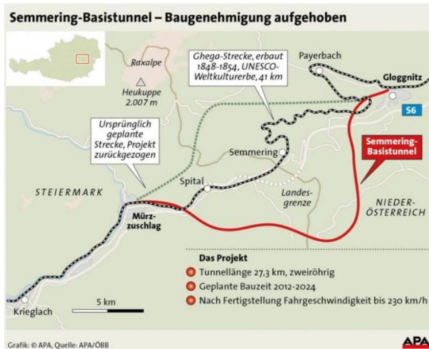
Abbildung 9: Visualisierung Semmering Basistunnel<sup>138</sup>
