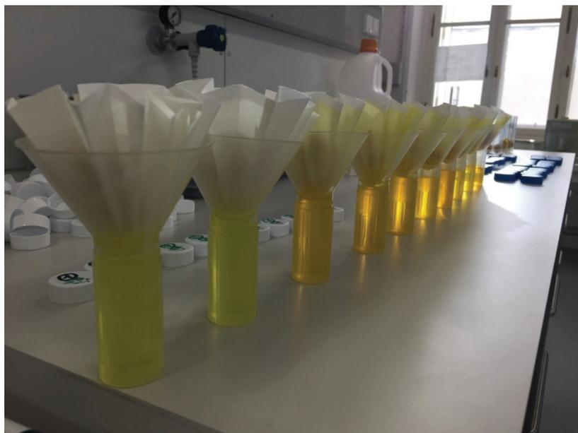
Abbildung 28: Überführung der Extrakte durch Rundfilter in 20 ml Szintillationsgefäße (eigenes Foto, 2017)
