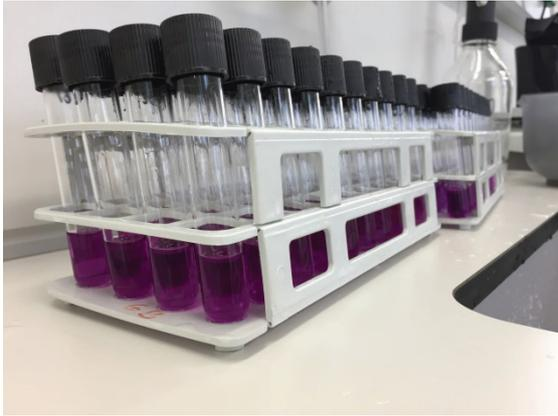
Abbildung 34: Proben in Kulturröhrchen - zur Bestimmung des Nitratgehaltes mit Farbreagenz versetzt (eigenes Foto, 2018)
