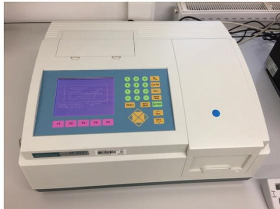
Abbildung 30: Spektralphotometer Metertech UV / VIS SP-8001 der Abteilung Gartenbau der BOKU (eigenes Foto, 2017)
