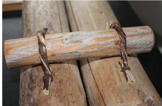
Abbildung 19: Befestigung mittels Floßklammer und Wiede, Modell im Forstmuseum Großreifling.
