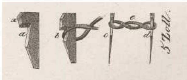
Abbildung 9: Darstellung der Verbindungsmethode "Zaum und Kegel" (Jägerschmid, 1827).
