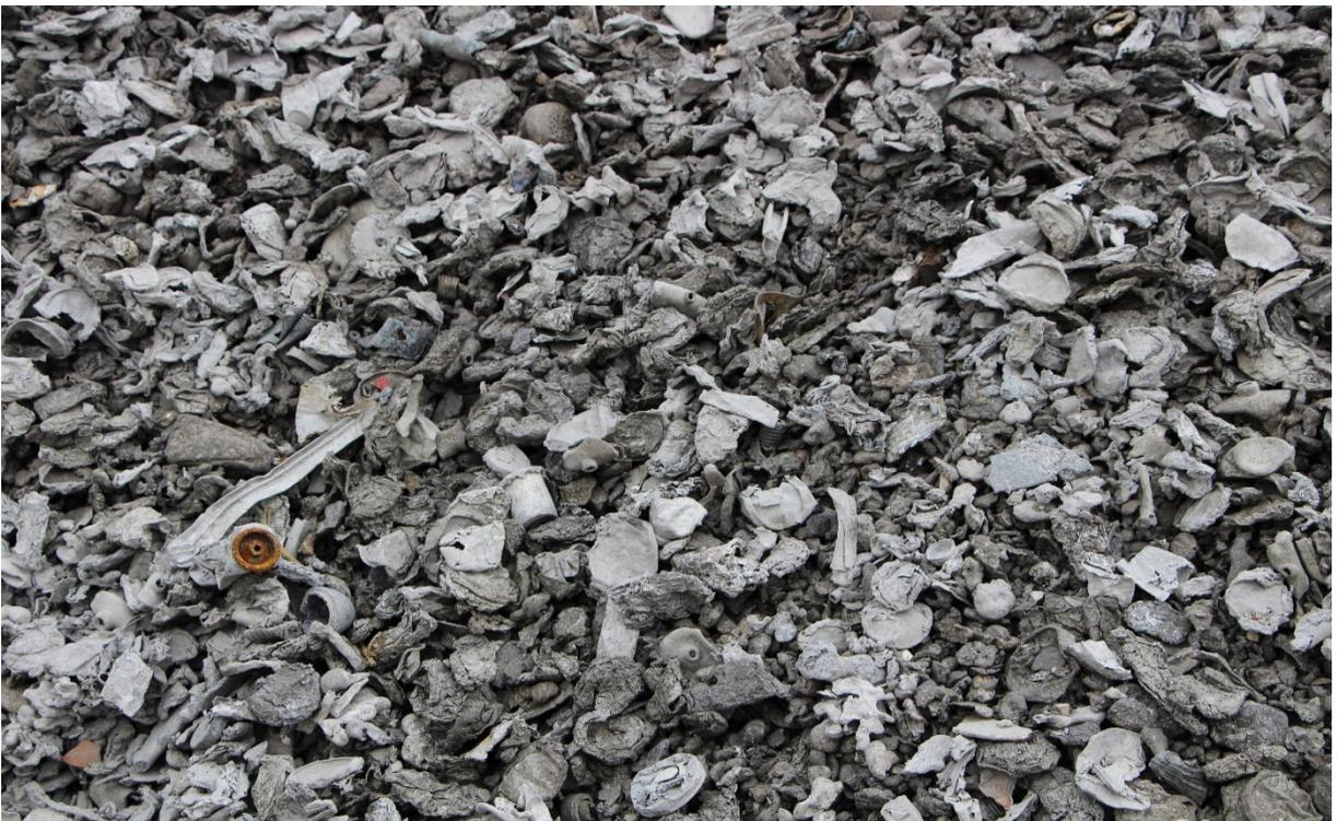
Abbildung 16: kleine Fe-Metalle nach der Schlackenaufbereitung (Warrings, 2017)
