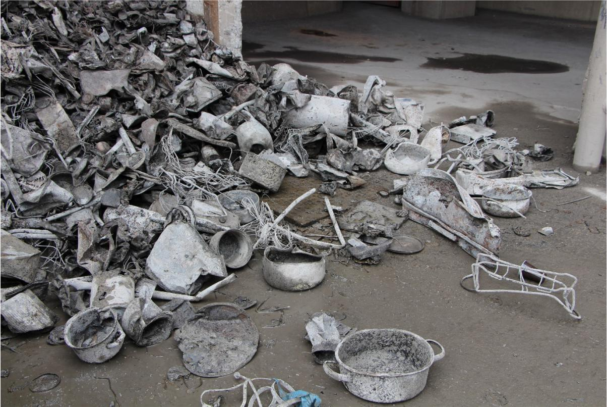
Abbildung 13: große Fe-Metalle nach der Schlackenaufbereitung (Warrings, 2017)
