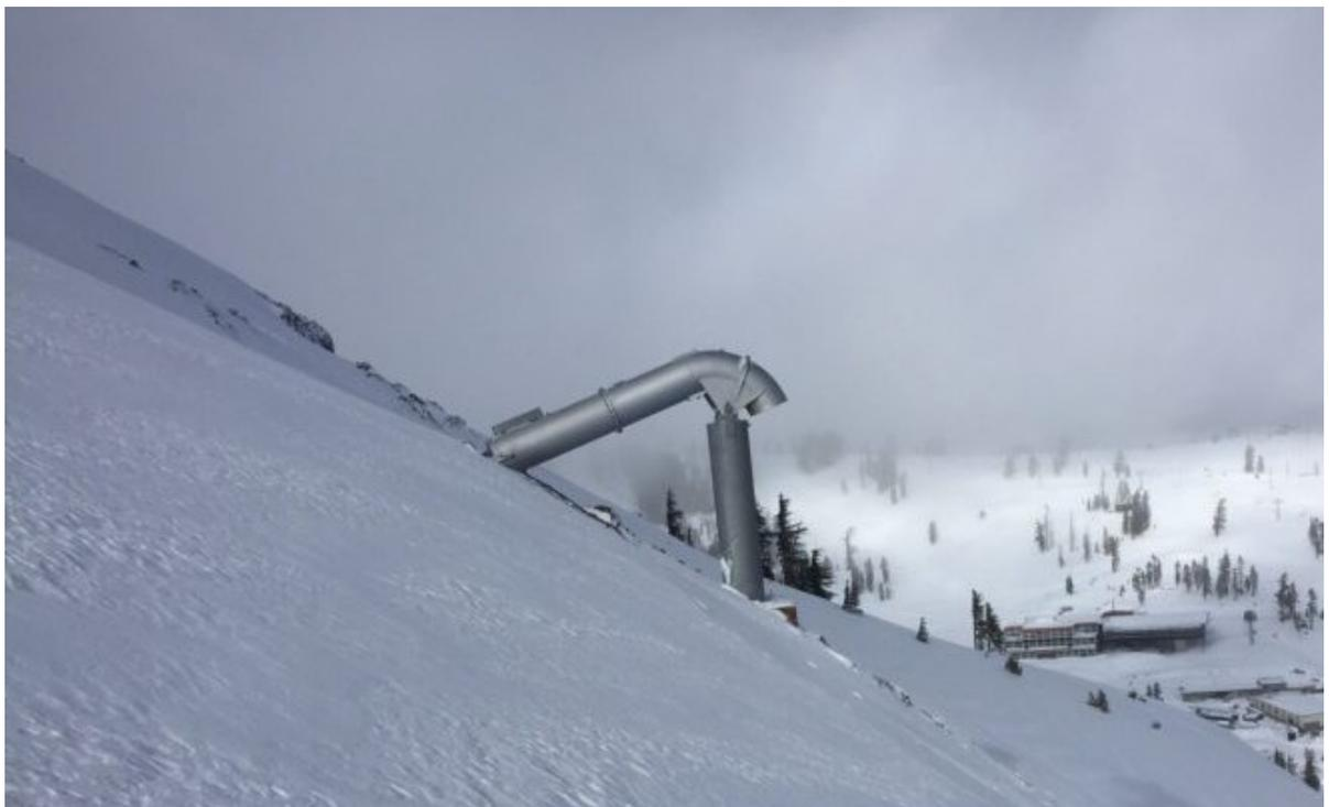
Abbildung 2.6: Das Zündrohr einer GAZ.EX-Anlage. (snowbrains.com, 2018)
