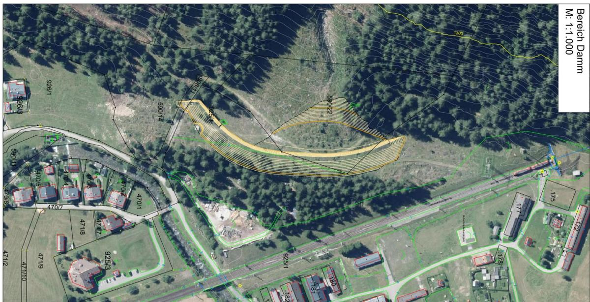
Abbildung 5.10: Empfohlene Position und Kubatur des ergänzenden Lawinenauffangdammes. (ÖBB Infrastruktur AG, 2015)
