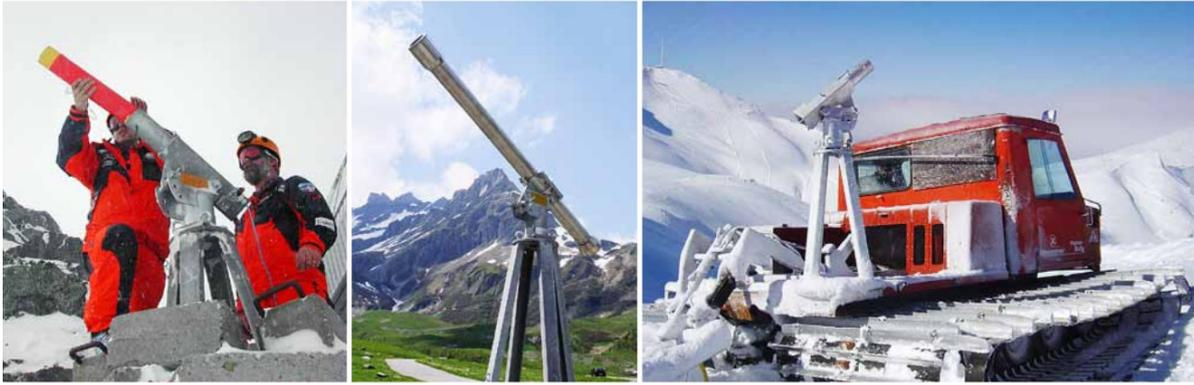
Abbildung 2.3: Die Lawinenpfeife der Firma Inauen-Schätti. Links im Bild wird sie gerade geladen. Im rechten Bild sieht man die mobile Version auf einem Pistengerät. (Inauen-Schätti, 2017).
