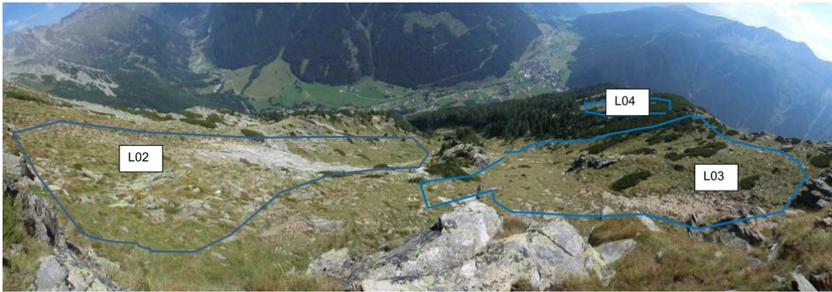
Abbildung 5.2: Blick ins Mölltal und den Ort Mallnitz aus dem Anbruchgebiet der Liesgele-Lawine. Im Bild blau eingezeichnet, die drei Anbruchgebiete L01, L02 und L04. Nicht im Bild befindet sich Anbruchgebiet L01. Es ist im linken Bildrand hinter einer Geländekante verborgen. (ÖBB Infrastruktur AG, 2015)
