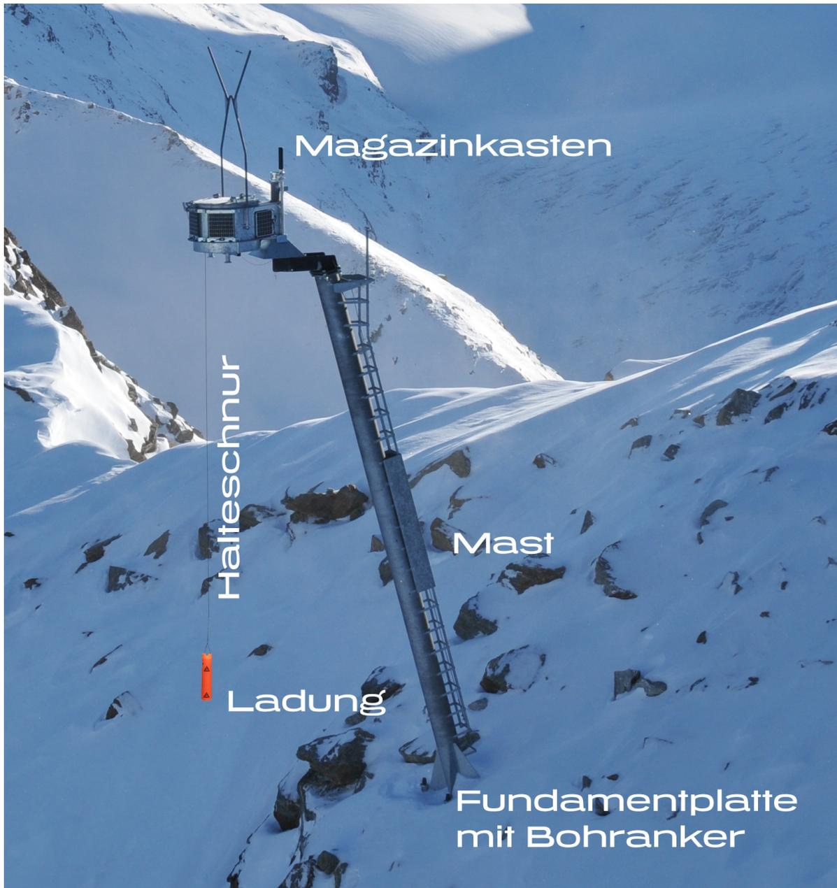
Abbildung 2.5: Ein Sprengmast der Firma Wyssen. Zu sehen ist die orange Sprengladung die an einer Leine aus dem Trommelmagazin an der Mastspitze hängt, kurz vor der Detonation. (Wyssen, 2018)
