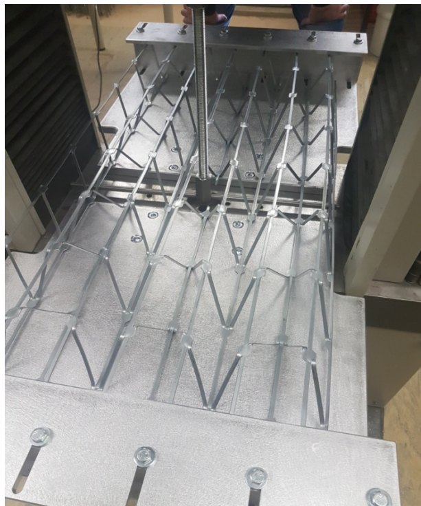
Abbildung 37: Versuchsaufbau für ein Gitter ohne Füllung und Bodenblech
