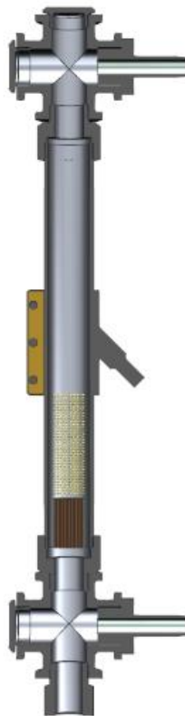
Abbildung 19: Innenansicht des Wirbelschichtreaktors mit dem darin enthaltenen Lewatit
