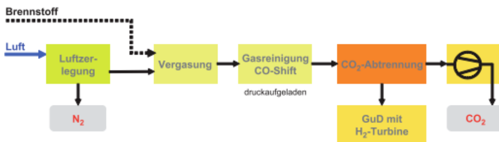
Abbildung 4: Schematische Darstellung eines Pre-Combustion Verfahrens [10]
