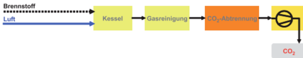
Abbildung 3: Schematische Darstellung eines Post-Combustion Verfahrens [10]
