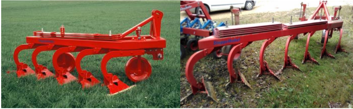
Abbildung 2: Stoppelhobel von der Firma Zobel aus Deutschland. Links: Seitenansicht mit fünf Scharen (Heilmann, 2013); rechts: Ansicht auf Rückseite, Stoppelhobel vom Versuchsbetrieb Karl Ringl mit sieben Scharen.
