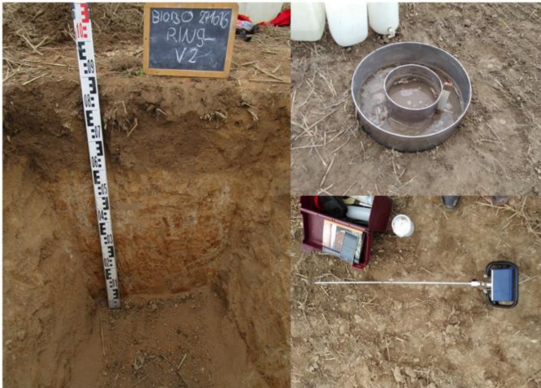
Abbildung 13: Bodenprofil (links), Doppelringinfiltrometer (rechts oben), Penetrometer (rechts unten)
