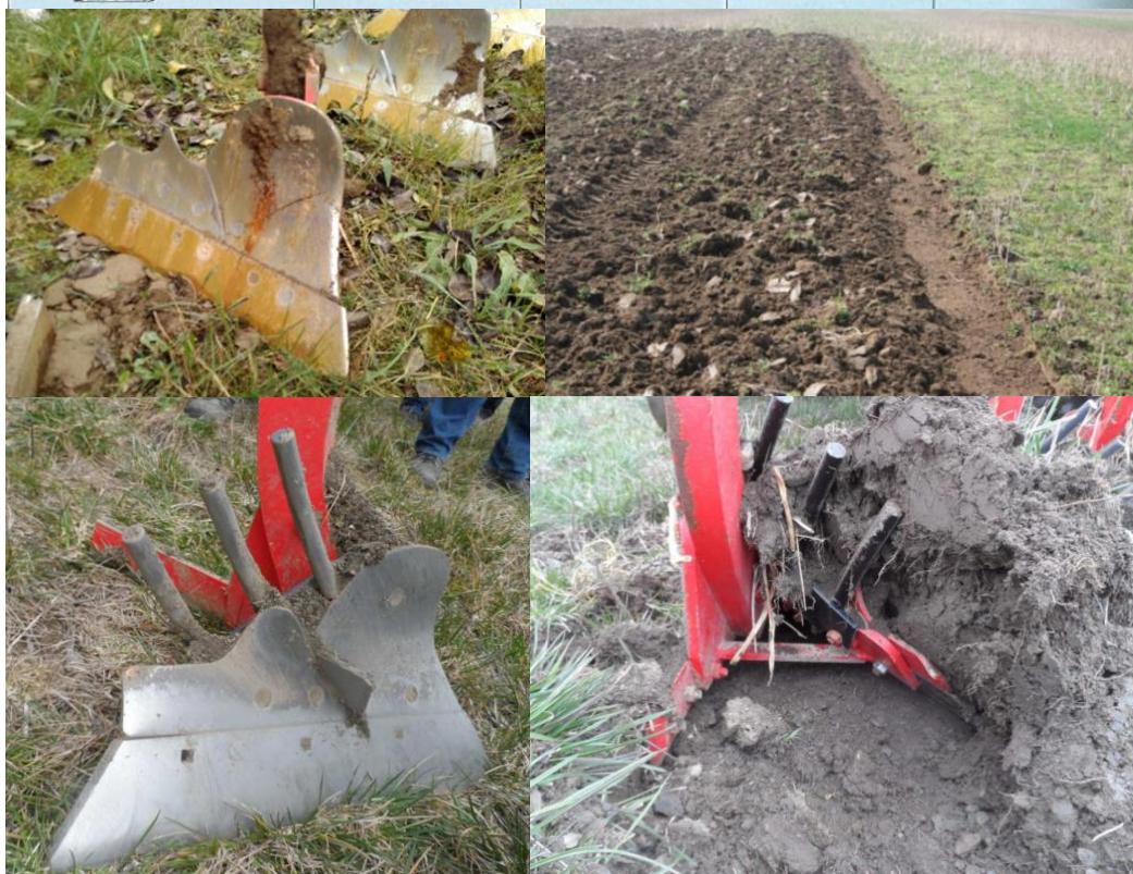
Abbildung 8: Oben: Übersicht von Pflugkörperformen und deren Einsatzbereiche (Schön, 1998, p. 180); Mitte links: Stoppelhobelschare (am Versuchsbetrieb); Mitte rechts: Schäl-furche mit 7 cm Bearbeitungstiefe von Stoppelhobel (Schmidtke, 2014, p. 25); unten rechts: Stoppelhobelschare mit Unterteilung und Rundstahlverlängerung des Streichblechs; unten links: abschälen einer Kleegrasuntersaat (Peszt, 2015, p. 8f)
