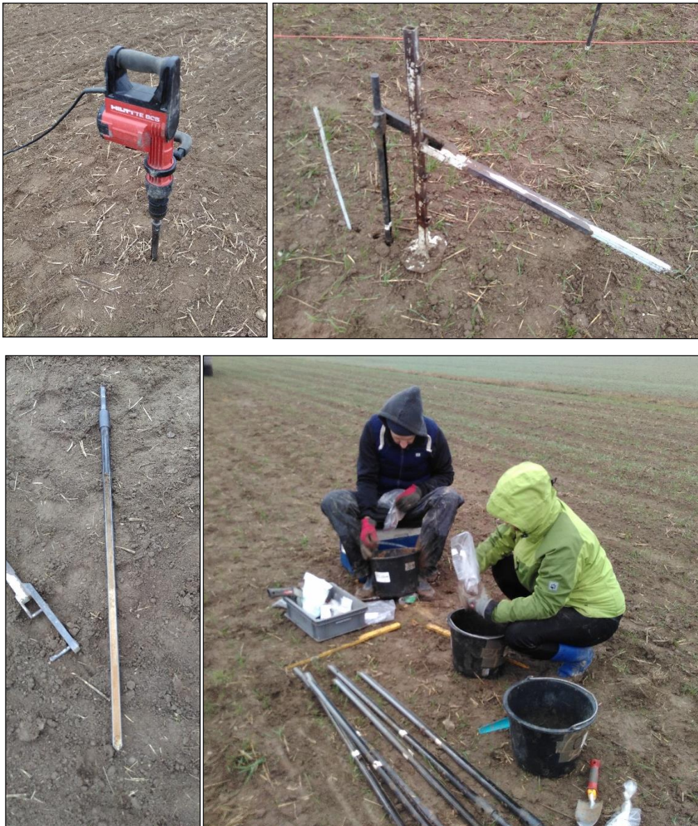
Abbildung 12: Meißelhammer Marke HILTI (links oben), Bohrstock mit Hebel zur Bergung des Bodenmaterials (rechts oben), Bohrstock mit Bodenmaterial (links unten), Trennung von Bodenmaterial aus Bohrkernen in drei Tiefenabschnitte (rechts unten)
