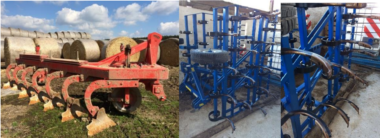
Abbildung 10: Stoppelhobel von der Firma Zobel (links) und Meißelschargrubber von der Firma Köckerling (Mitte und rechts)
