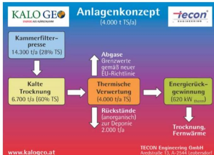
Abbildung 22: Kalogeo Anlagenkonzept (TECON ENGINEERING GMBH, zit. bei (KÜGLER, et al., 2004, S. 22)).
