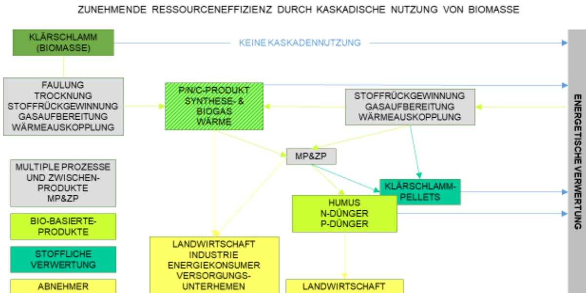
Abbildung 29: Kaskadennutzung von Biomasse nach Fehrenbach et al. (2017, S. 28) (Eigene Darstellung).
