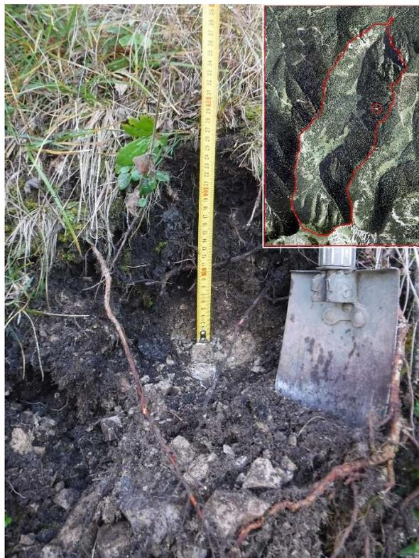
Abbildung 10: Bodenaufschluss am Böschungsabbruch neben einer Forststraße (15.09.2019)
