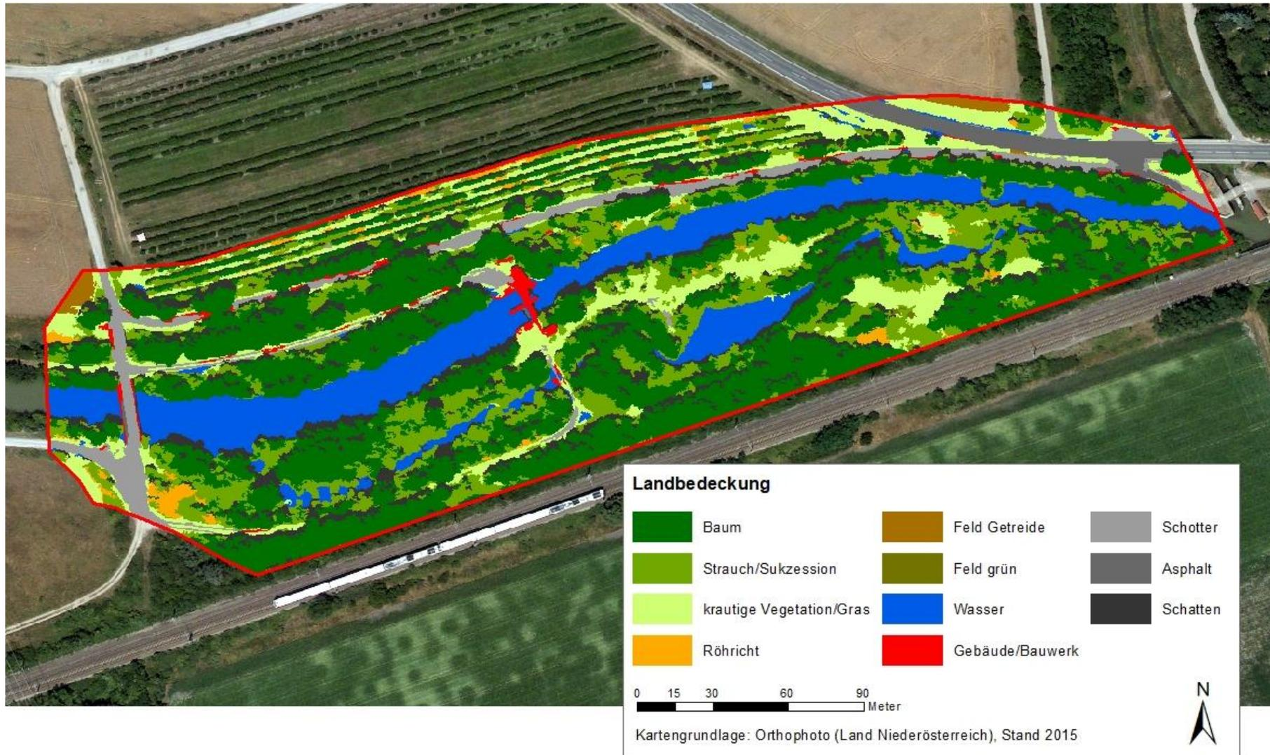
Abb. 11: Ergebniskarte der OBIA des Orthophotos (Aufnahmejahr 2015)
