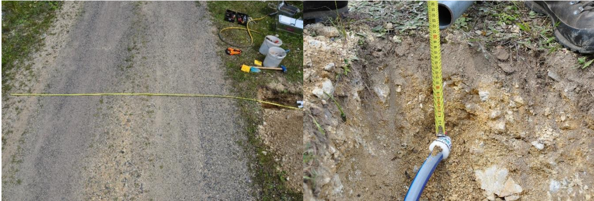
Abbildung 10: links: Lage des Profils mit den Sensoren, rechts: Einbau des dritten Sensors
