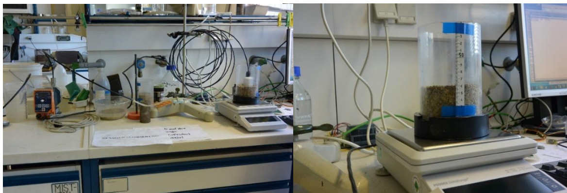
Abbildung 8: Kalibrierungsvorgang des Sensors
