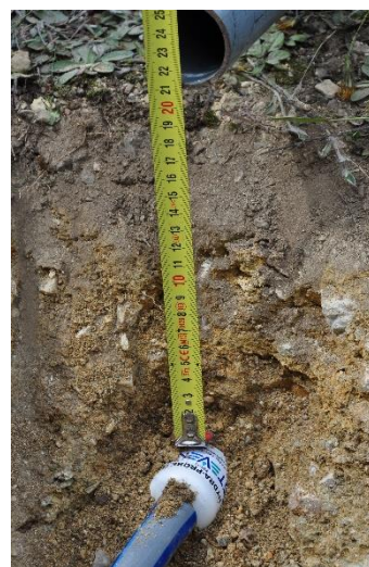
Abbildung 9: Links: Lage der Hydra Probe Sensoren im Straßenprofil, rechts: Lage höchstgelegener Sensor
