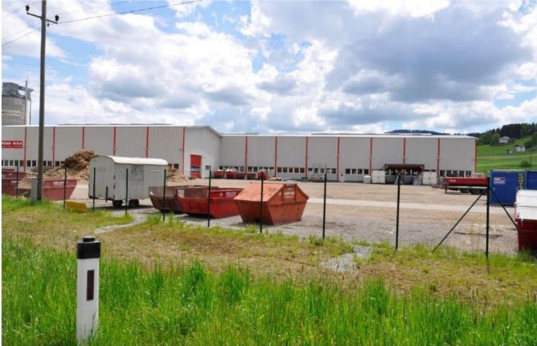
Abb. 5-6: Beispiel 5 für Schwierigkeiten bei der Bewertung von Entwässerungseinrichtungen, eig. Darst. Beispiel 5 zeigt den Rangier- und Lagerplatz eines Gewerbebetriebes. Die Fläche weist offensichtlich keinerlei Entwässerungseinrichtungen auf, noch eine einheitliche Oberfläche (teils befestigt, teils unbefestigt). Auch das Gelände fällt nicht eindeutig in eine Richtung, das Auftreten größerer Pfützen bei Niederschlägen scheint wahrscheinlich zu sein.
