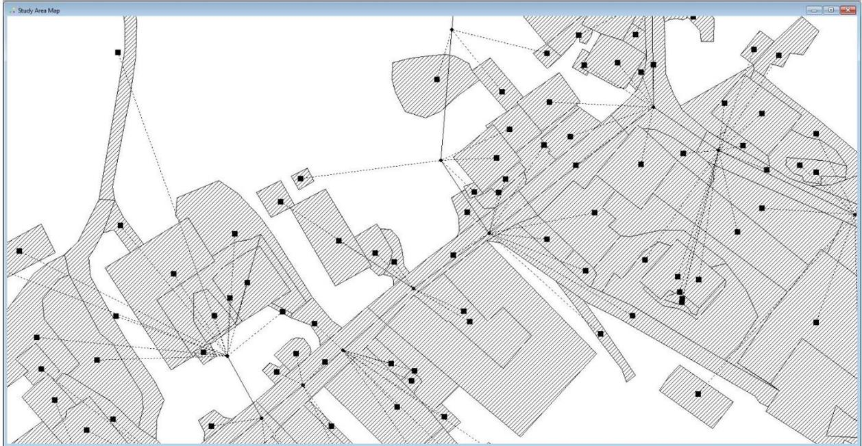
Abb. 5-30: Darstellung gleich an Knoten verwiesener Flächen in SWMM - Detail, eigene Darstellung
