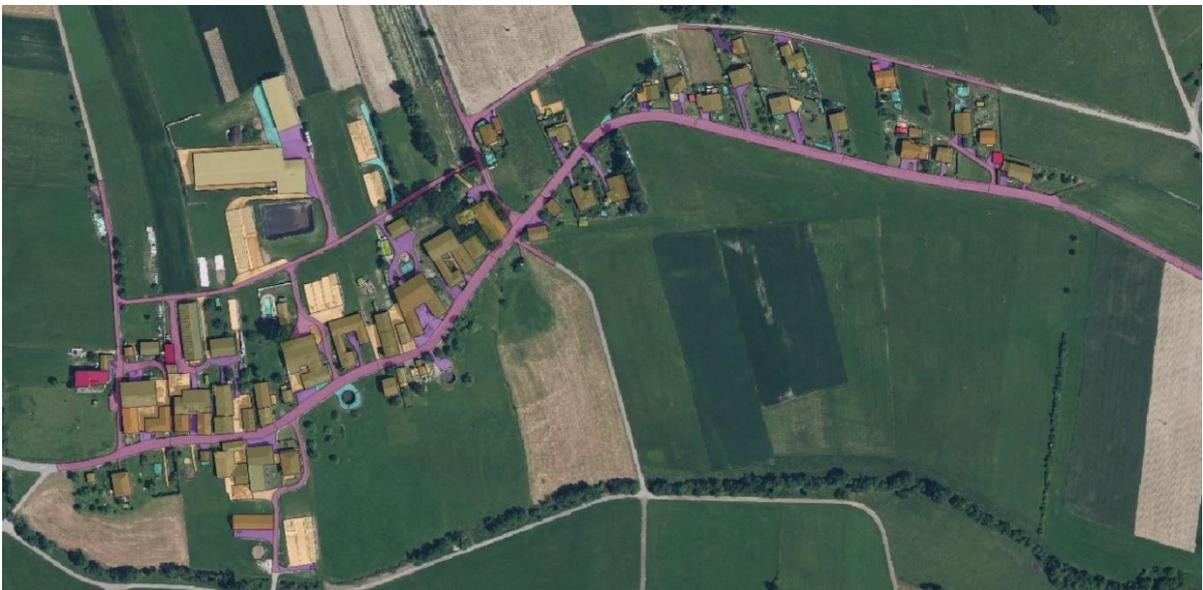
Abb. 5-9: Teilgebiet zur Quantifizierung des Anteils nicht angeschlossener Flächen, eigene Darstellung
