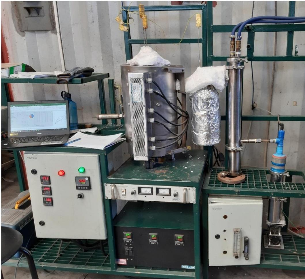
Abbildung 28: Versuchsaufbau Festbettreaktor am UDT (Eigene Darstellung)
