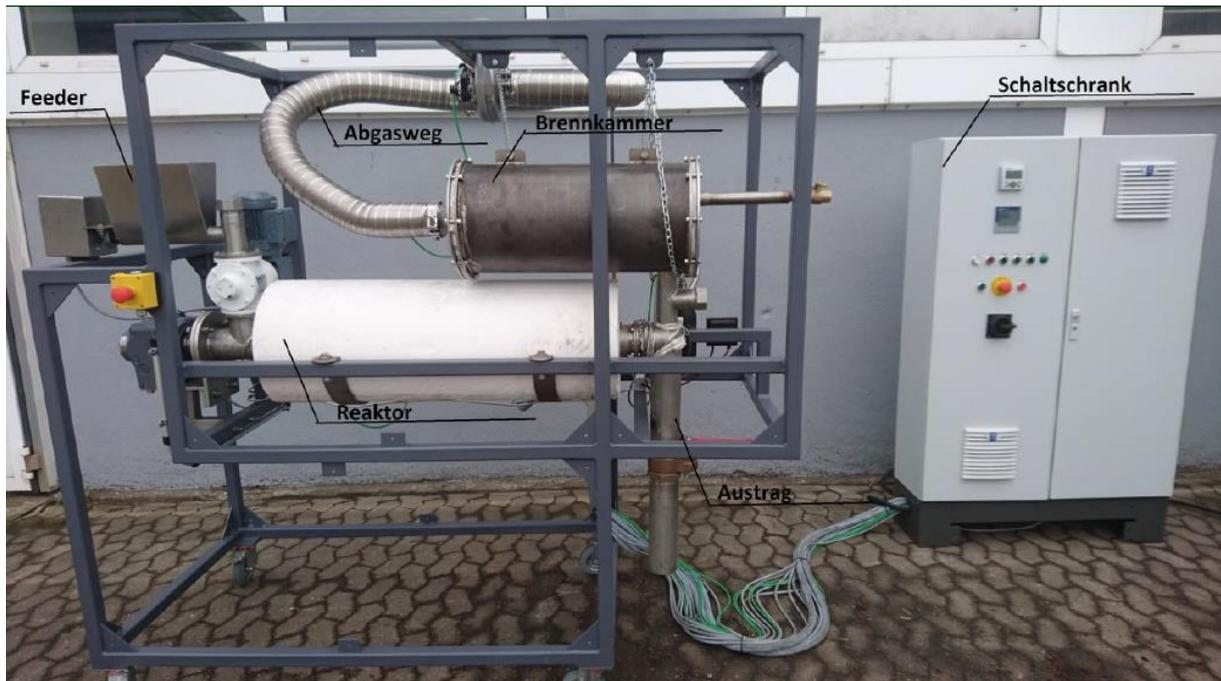
Abbildung 25: Pyreka Schneckenreaktor mit Komponentenbezeichnung (Pyreg, 2016)
