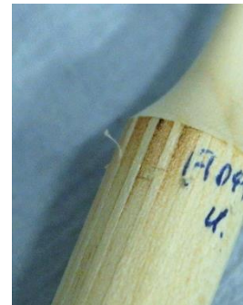
Abbildung 4.5 Verfärbung einer Probe an der Unteren Einspannung durch Testprozedere
