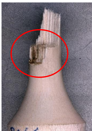
Abbildung 4.13 Abbildung der Bruchfläche von Probe A066 nach der Ultraschallbelastung
