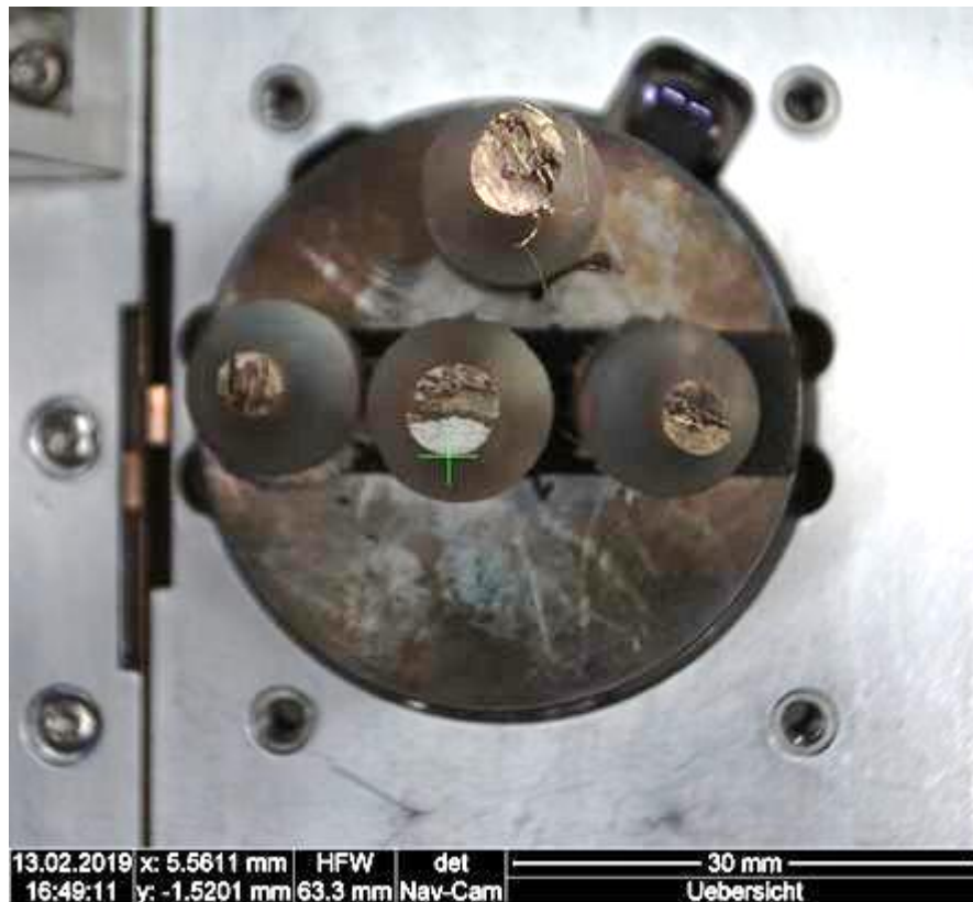
Abbildung 0.42 A009 – Übersichtsbild der Bruchflächenaufnahme mit REM - Positionierung der Aufnahme nach Fadenkreuz
