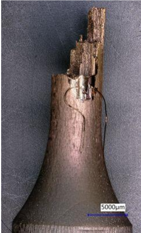
Abbildung 0.24 A067; Zug-Druck Spannungsbruch im Ultraschallbereich bei 96,57 MPa gewichtete Spannungsschwingbreite bei 3,55 \times 10^4 Zyklen
