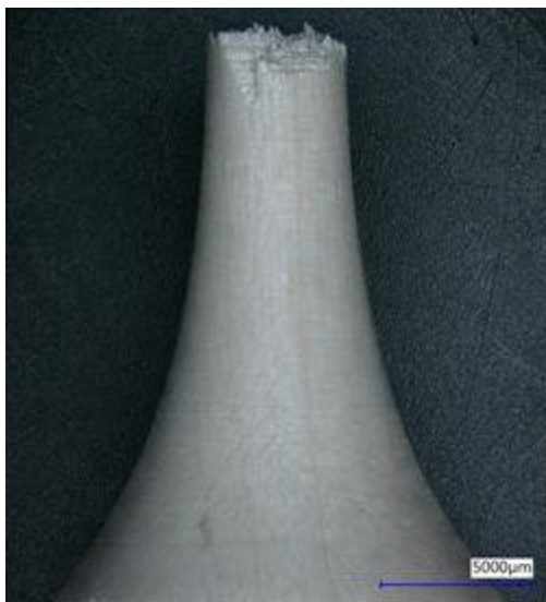
Abbildung 0.15 Probe A026; Zugspannungsbruch bei 103,37 MPa gewichtete Spannungsschwingbreite bei 7,51 \times 10^4 Zyklen
