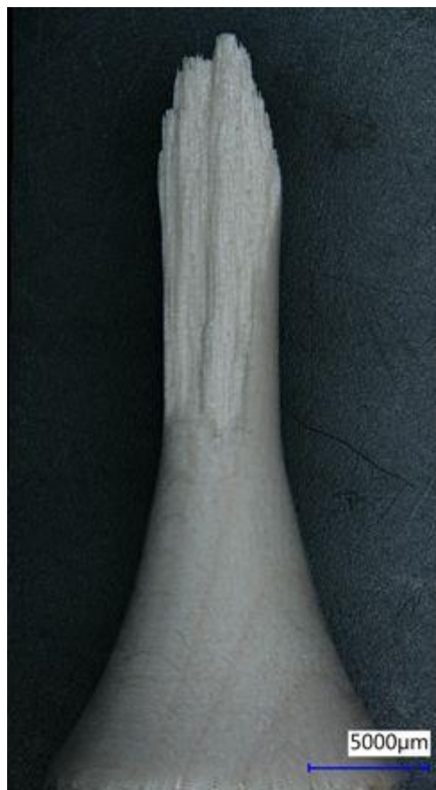
Abbildung 0.3 Probe A032; Zugspannungsbruch bei 115,53 MPa gewichtete Spannungsschwingbreite bei 8,83 \times 10^3 Zyklen
