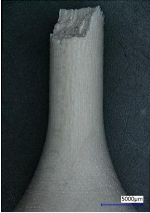
Abbildung 0.2 Probe A020; Druckspannungsbruch bei -50,80 MPa gewichtete Spannungsschwingbreite bei 2,82 \times 10^3 Zyklen
