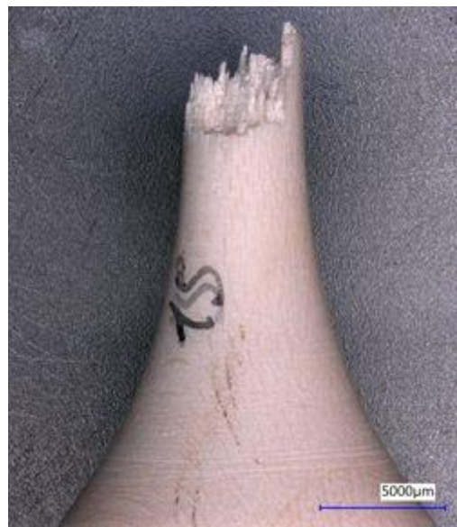
Abbildung 0.18 A015; Zug-Druck-Spannungsbruch bei 92,25 MPa gewichtete Spannungsschwingbreite bei 1,46 \times 10^5 Zyklen
