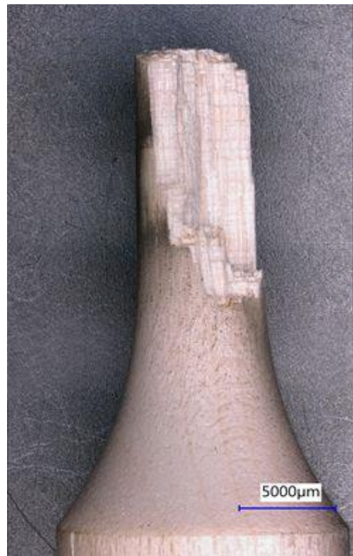
Abbildung 0.26 A065; Zug-Druck Spannungsbruch im Ultraschallbereich bei 50,37 MPa gewichtete Spannungsschwingbreite bei 1,49 \times 10^7 Zyklen
