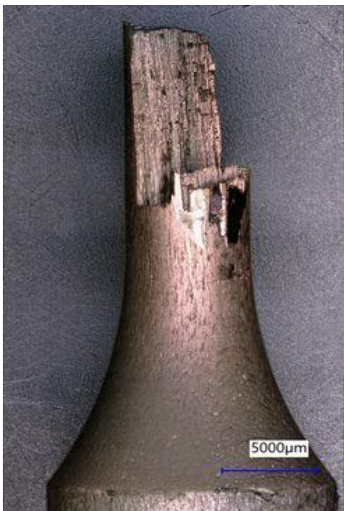
Abbildung 0.27 A056; Zug-Druck Spannungsbruch im Ultraschallbereich bei 2,68 \times 10^6 MPa gewichtete Spannungsschwingbreite bei 2,68 \times 10^6 Zyklen
