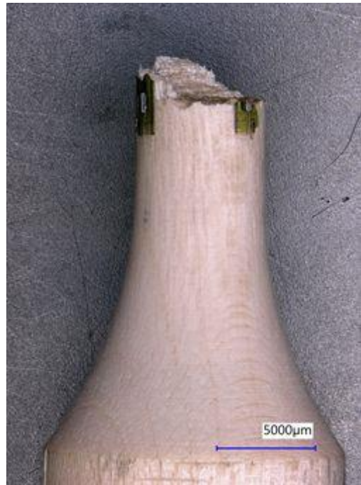
Abbildung 0.32 A054; Zug-Druck Spannungsbruch im Ultraschallbereich bei 41,90, MPa gewichtete Spannungsschwingbreite bei 1,92 \times 10^8 Zyklen
