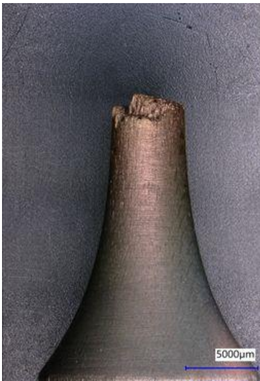
Abbildung 0.19 Probe A012; Zug-Druck-Spannungsbruch bei 95,36 MPa gewichtete Spannungsschwingbreite bei 4,35 \times 10^3 Zyklen
