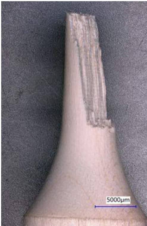
Abbildung 0.30 A063; Zug-Druck Spannungsbruch im Ultraschallbereich bei 58,46 MPa gewichtete Spannungsschwingbreite bei 6,52 \times 10^4 Zyklen
