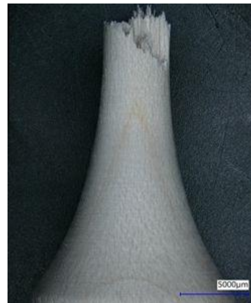
Abbildung 0.16 Probe A028; Zugspannungsbruch bei 93,63 MPa gewichtete Spannungsschwingbreite bei 7,87 \times 10^4 Zyklen
