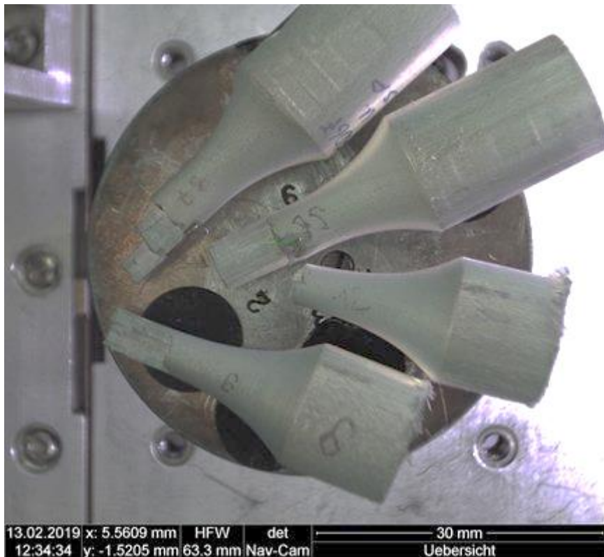
Abbildung 0.34 Probe A056 – Übersichtsbild der Bruchflächenaufnahme mit REM - Positionierung der Aufnahme nach Fadenkreuz
