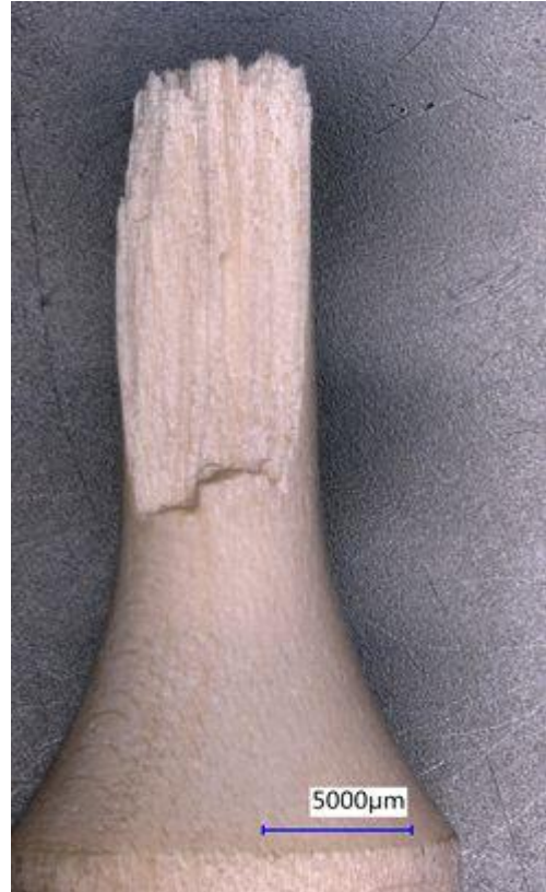
Abbildung 0.25 A055; Zug-Druck-Spannungsbruch im Ultraschallbereich bei 93,38 MPa gewichtete Spannungsschwingbreite bei 8,87 \times 10^2 Zyklen
