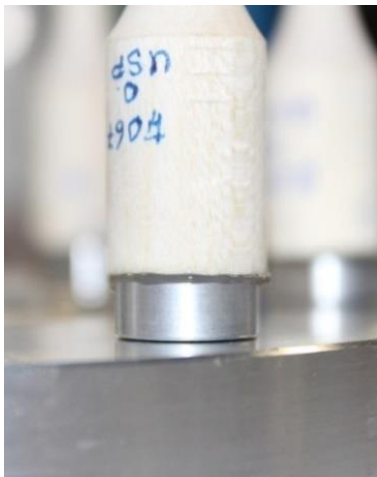
Abbildung 4.2 Darstellung einer gesockelten Probe für die Ultraschallmessung
