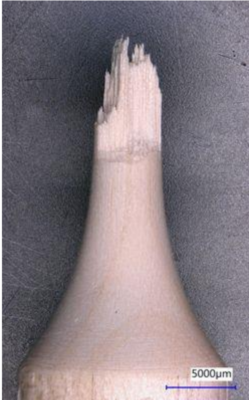
Abbildung 0.21 A010; Zug-Druck-Spannungsbruch bei 86,85 MPa gewichtete Spannungsschwingbreite bei 1,29 \times 10^3 Zyklen
