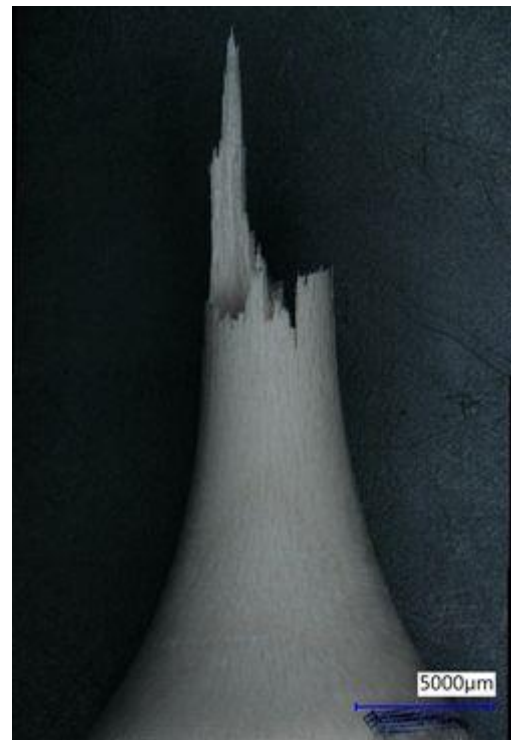
Abbildung 0.4 Probe A038; Zugspannungsbruch bei 122,02 MPa gewichtete Spannungsschwingbreite bei 1,85 \times 10^5 Zyklen
