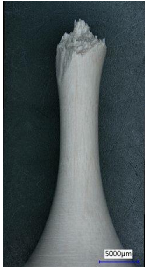
Abbildung 0.9 Probe A037; Zugspannungsbruch bei 111,71 MPa gewichtete Spannungsschwingbreite bei 4,80 \times 10^3 Zyklen
