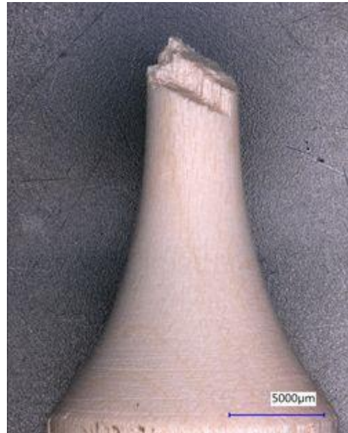
Abbildung 0.20 A004; Zug-Druck-Spannungsbruch bei 80,70 MPa gewichtete Spannungsschwingbreite bei 1,38 \times 10^5 Zyklen
