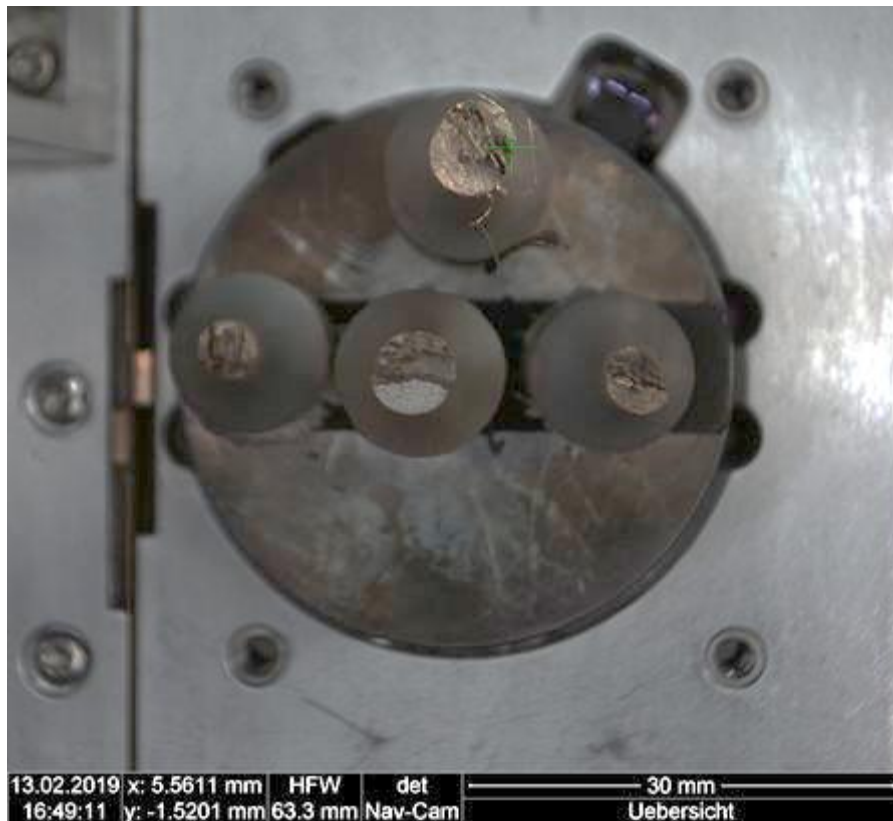
Abbildung 0.47 A067 – Übersichtsbild der Bruchflächenaufnahme mit REM - Positionierung der Aufnahme nach Fadenkreuz
