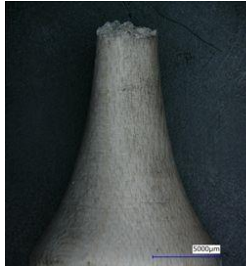
Abbildung 0.5 Probe A030; Zugspannungsbruch bei 125,78 MPa gewichtete Spannungsschwingbreite bei 2 Zyklen
