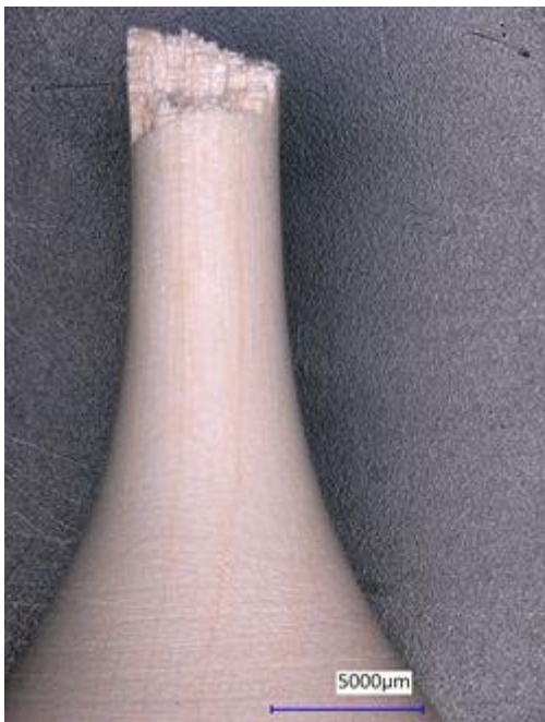
Abbildung 0.23 A011; Zug-Druck-Spannungsbruch bei 72,81 MPa gewichtete Spannungsschwingbreite bei 2,54 \times 10^5 Zyklen
