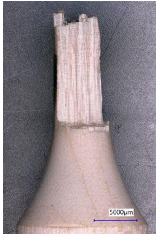
Abbildung 0.31 A053; Zug-Druck Spannungsbruch im Ultraschallbereich bei 56,46 MPa gewichtete Spannungsschwingbreite bei 3,98 \times 10^8 Zyklen
