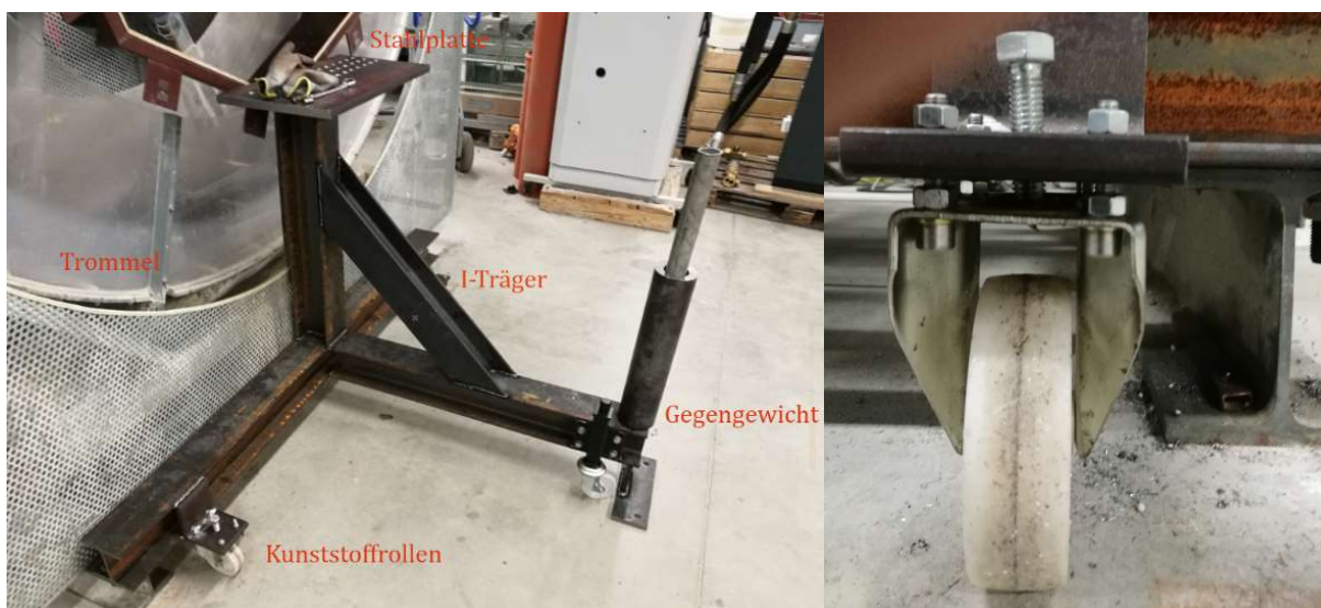
Abbildung 9: Links die Halterung für die Messfinne und rechts die Kunststoffrollen mit verstellbaren Schrauben zur Höheneinstellung.
