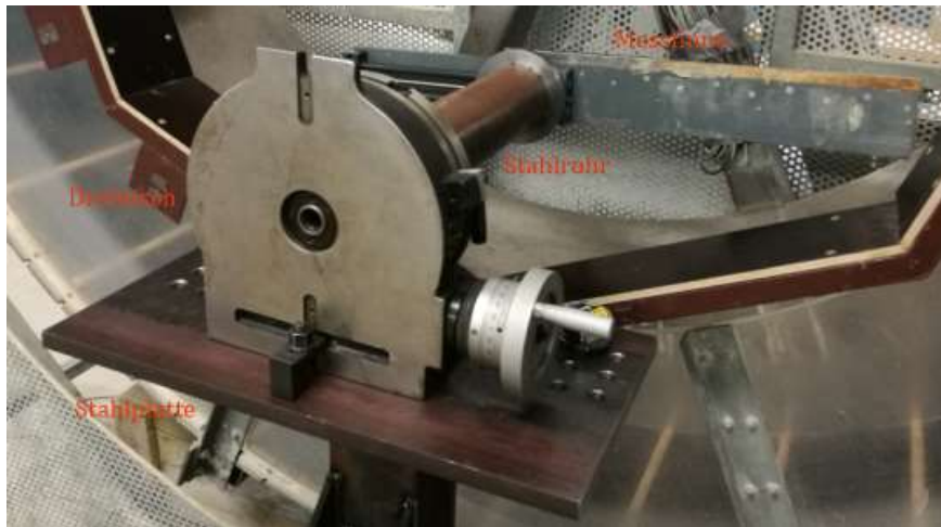
Abbildung 10: Drehtisch mit Stahlrohr und Messfinne ohne Verkabelung
