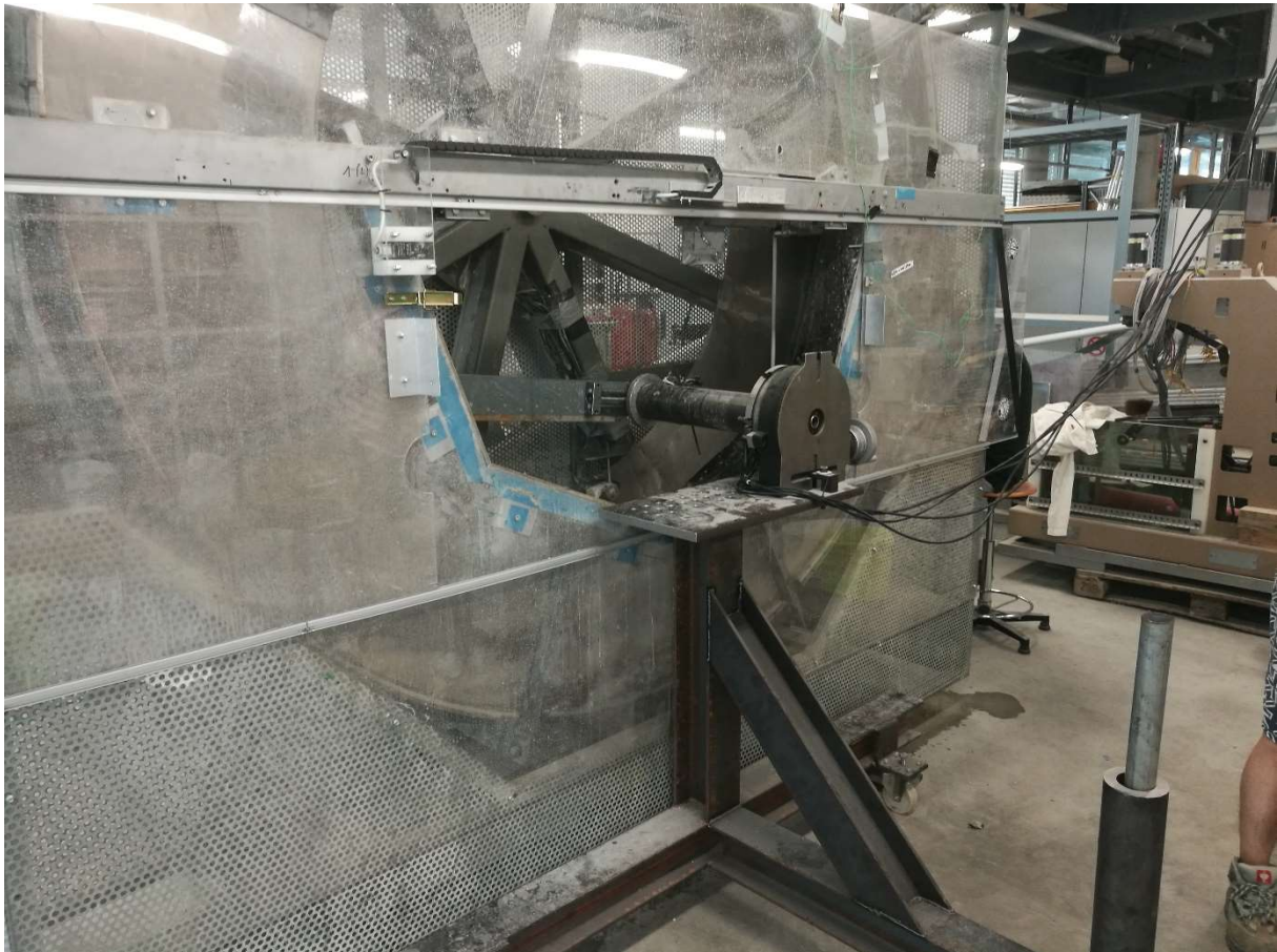
Abbildung 15: Messsystem in der Trommel unmittelbar vor dem Versuchsstart
