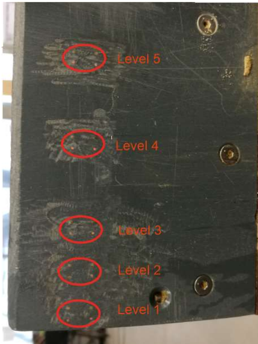
Abbildung 12: Unterer Teil der Messfinne mit den bearbeiteten Leveln 1 – 5.
