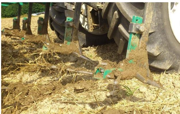
Abbildung 6: Häufelpflug mit aufmontierten Drähten
