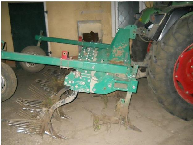
Abbildung 4: Häufelpflug mit aufmontierten Häufelkörpern
