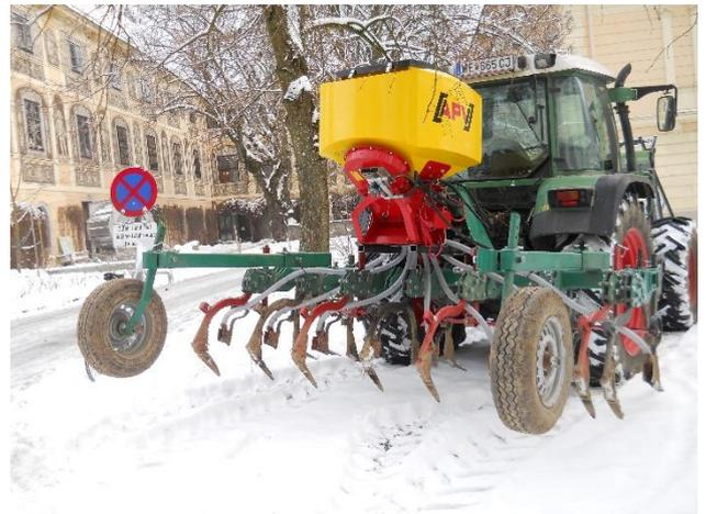
Abbildung 5: Häufelpflug mit aufgebautem Säkasten
