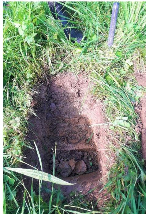
Abbildung 18: Stechzylinder eingeschlagen in den Boden (eigene Aufnahme)
