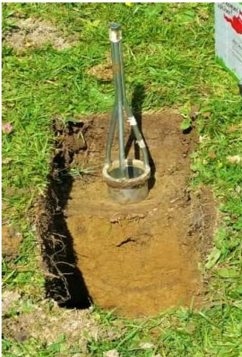
Abbildung 17: Stechzylinder mit aufgesetztem Schlageisen (eigene Aufnahme)
