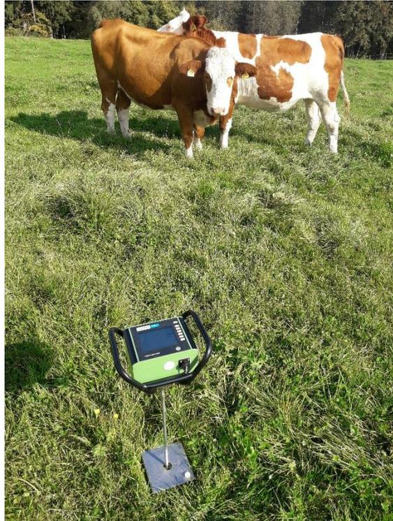
*Abbildung 19: Messung des Eindringwiderstandes mit dem Penetrologger (eigene Aufnahme)*
